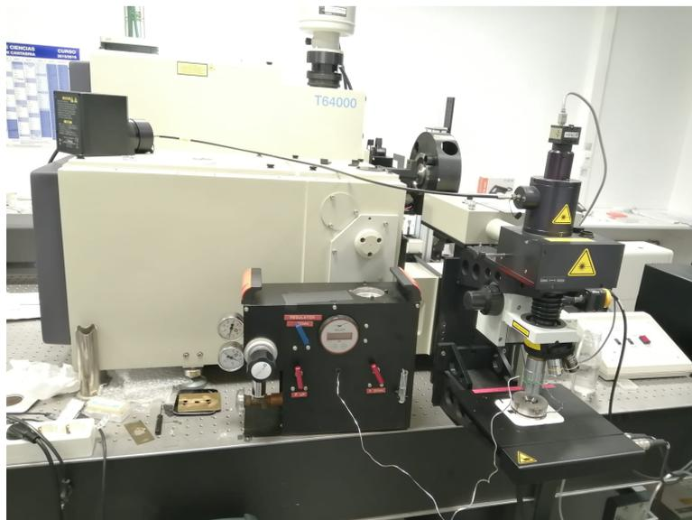
*Figura 2.5: Dispositivo experimental utilizado para las medidas del espectro Raman de la sílica a altas presiones. Se muestra el sistema que genera el láser utilizado y la celda sobre la platina, lista para las medidas.*
