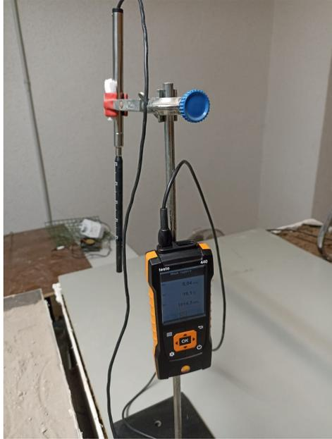
Figura 3.14: Sensor que mide la velocidad del viento y pantalla donde observar los datos.
