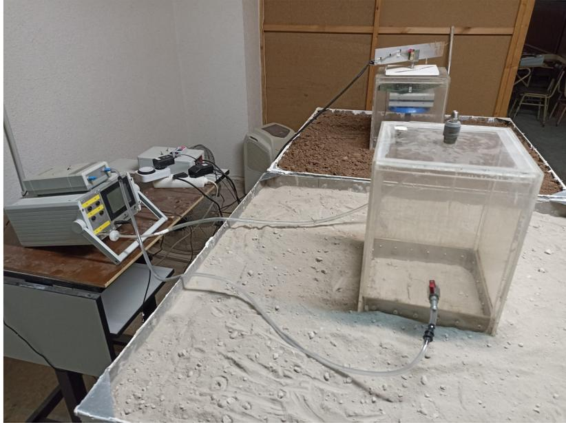
Figura 3.7: Dispositivo utilizando la vitrina para las medidas realizadas por el método de acumulación.
