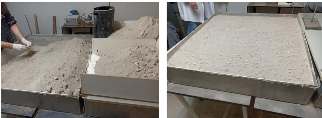
Figura 3.3: Imágenes del proceso de homogeneización. La imagen de la izquierda se realizó durante el cribado y homogeneización mientras que la imagen de la derecha está tomada cuando el suelo está listo para ser analizado.
