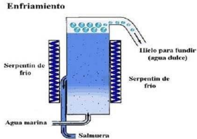
Imagen 61: Congelación por expansión. Fuente: ATRIA Innovation.
