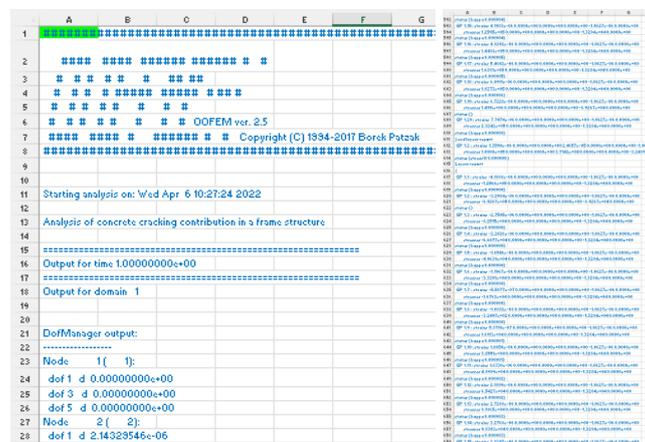
Figura 129 Casilla resaltada donde pegar el output de OOFEM y vista del output pegado en Excel. Fuente: elab. propia
