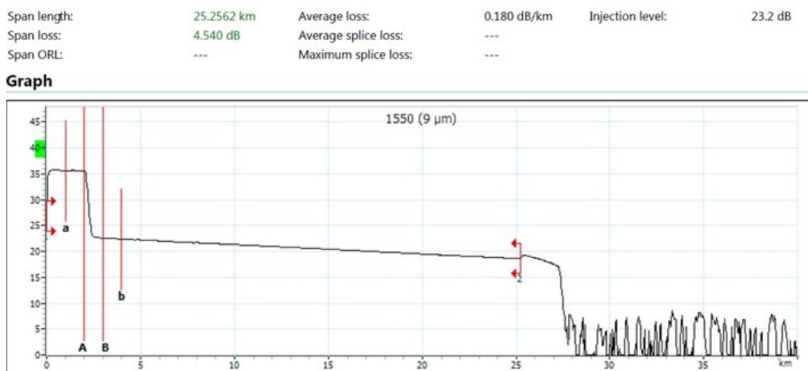
Figura 5.5: Resultados de la medición de la longitud de la fibra óptica de retardo.
