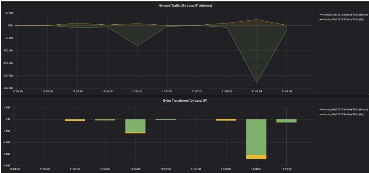
Figura 4.16 Ejemplo del tráfico capturado en una sesión haciendo uso del dispositivo Honor9, mostrando datos de la URL <http://IPdelGestor:3000>. En este caso se visualizan el tráfico generado y los Bytes transferidos por la dirección IP que se está controlando
