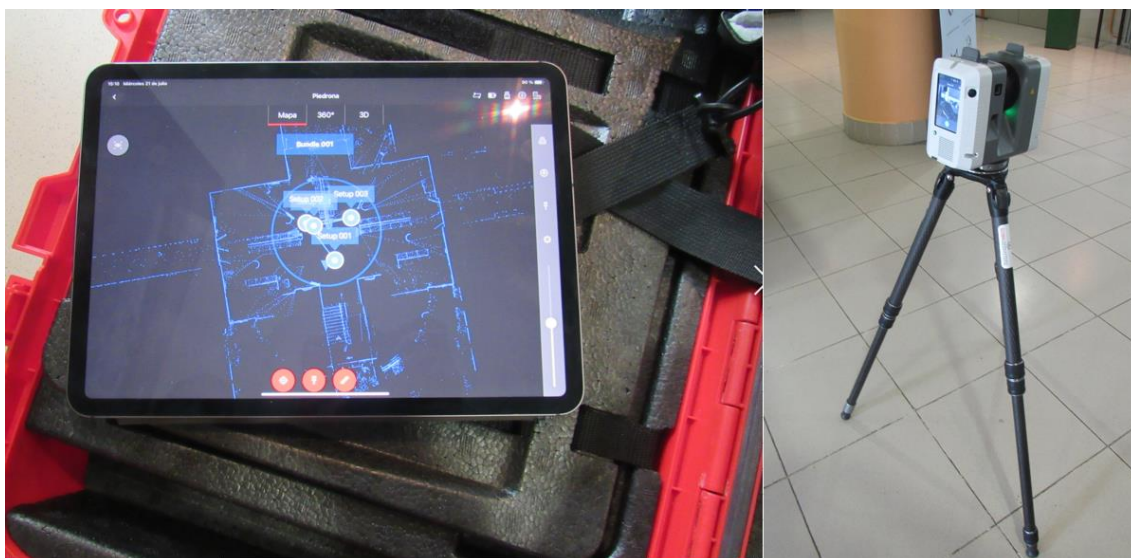
Figura 6.1. Dispositivo controlador con el software Leica Cyclone Field 360 y el Láser Escáner RTC360 3D
