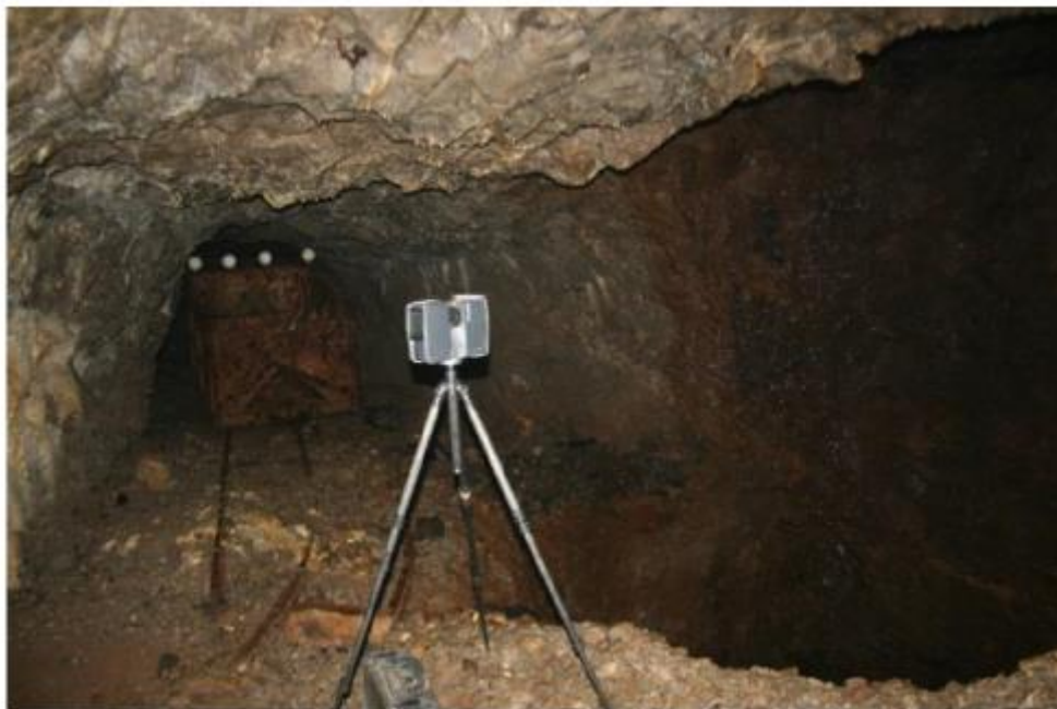
Figura 1.5. Láser escáner FARO Focus 3D estacionado junto a entronque del Pozo de La Cuerre [2]
