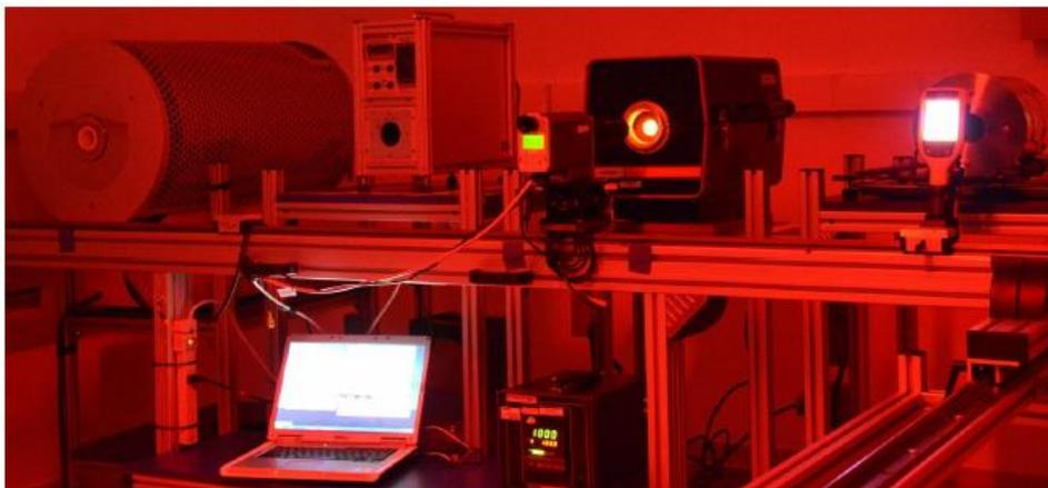
*Figura 4.34. Determinación de la emisividad efectiva mediante el empleo de técnicas experimentales. Fuente: [5]*
