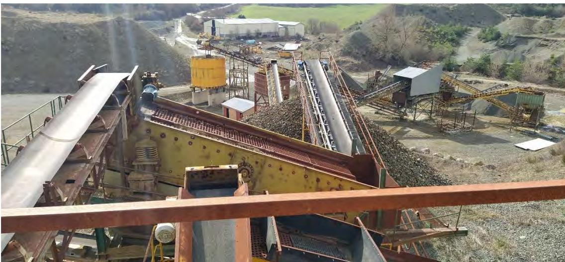
*Ilustración 7.19. Vista de conjunto de las cribas (incluida la de balasto) (Elaboración propia)*
