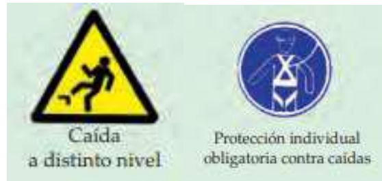
Ilustración 46. Señalización de seguridad de acceso a las cubiertas.
