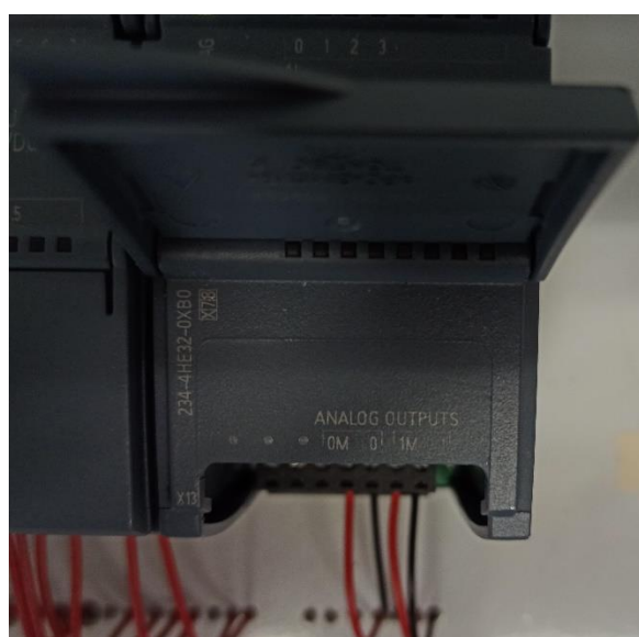
Figura 35. Módulo añadido de 4 entradas y 2 salidas analógicas.
