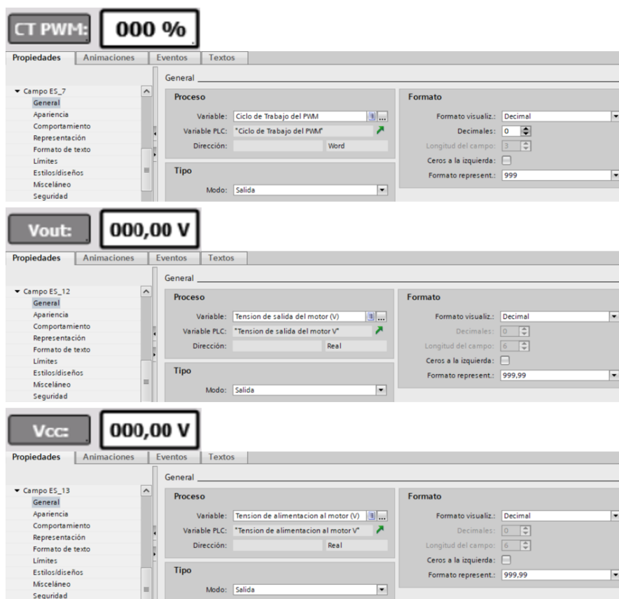
Figura 119. Cuadros de lectura del estado del motor.
