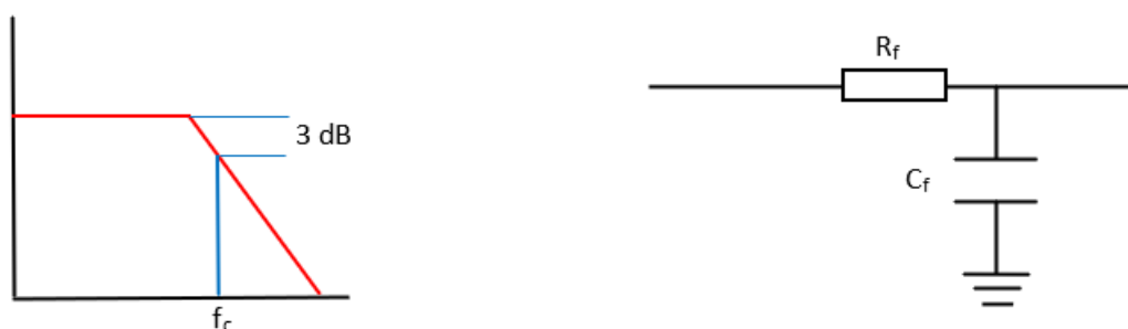
Figura 27. Esquemático y gráfica de un filtro paso bajo.
