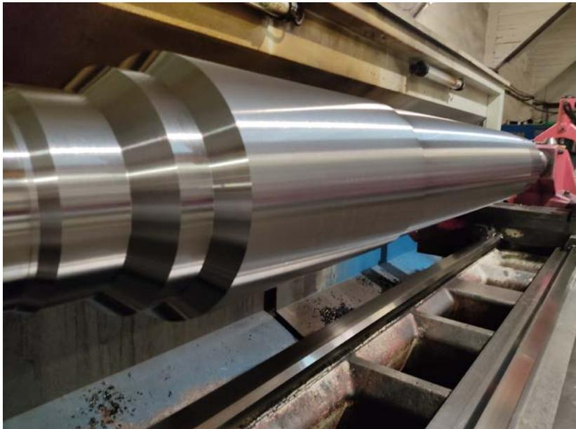
Ilustración 3 Rotor en proceso de mecanizado
