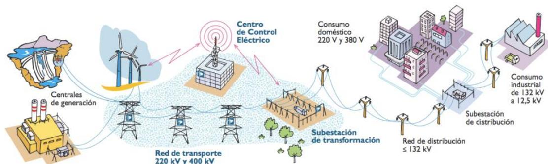
Figura 6 Estructura de un sistema eléctrico de potencia. (Fuente: REE)
