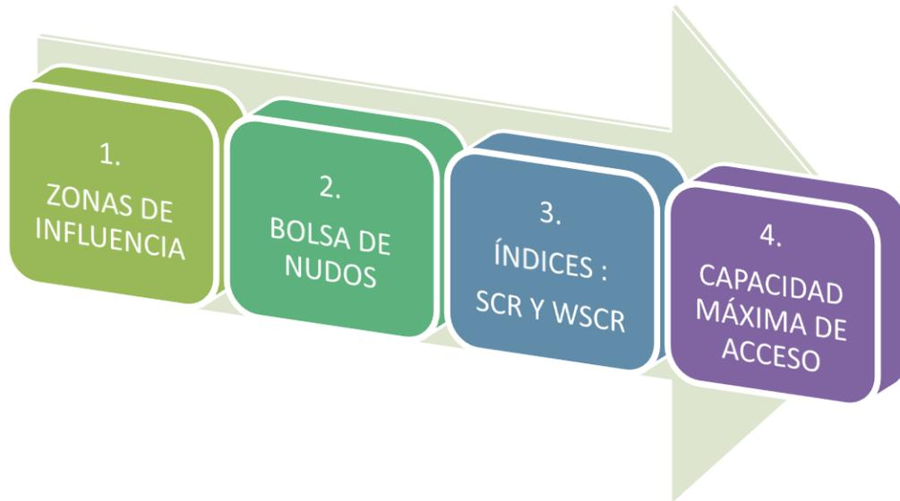
Figura 16 Estructura a seguir para el cálculo de la capacidad máxima de acceso.
