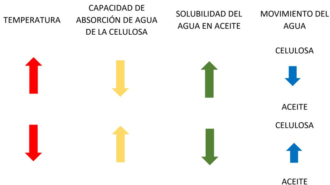
Figura 2.14 Esquema de la dinámica de humedad
