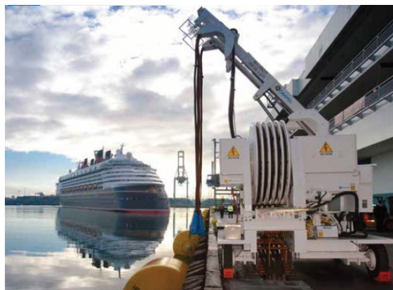
Ilustración 13: Sistema de gestión de cable móvil, sin instalación fija en el muelle. Fuente: Cavotec
