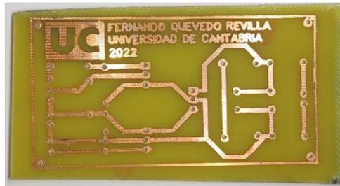
Figura 4.38: Resultado tras la retirada de la máscara y el taladrado.
