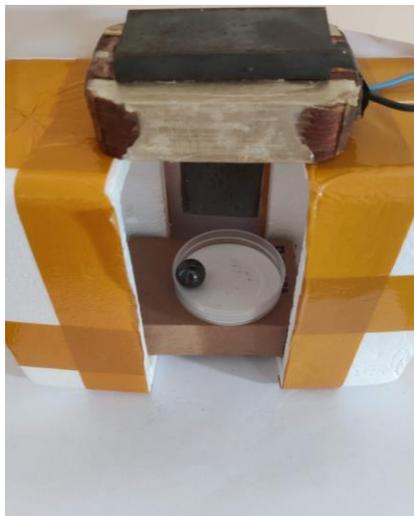
*Figura 1.12: Primer prototipo de levitador magnético.*
