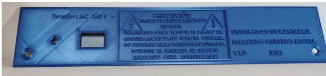
Figura 5.12 Resultado de la impresión de la tapa trasera.
