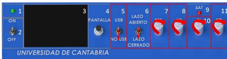
Mueva el selector 6 a la posición “LAZO CERRADO”, tras ello internamente se ejecutará el control mediante un regulador PID, con las ganancias ajustables a través de las ruletas 8, 10 y 11. Se permite variar la consigna girando la ruleta de referencia 7.
