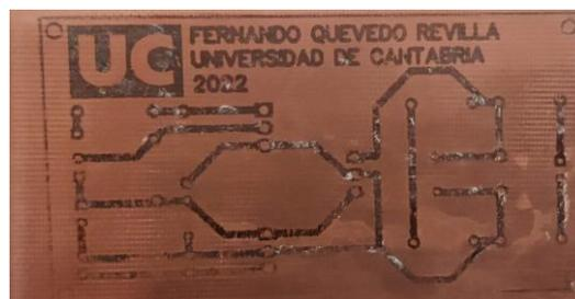
Figura 4.30: Resultado de la transferencia de la máscara a la superficie de la PCB.
