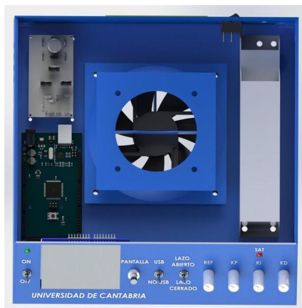
Figura 4.2: Modelo CAD, Distribución en planta de los elementos principales.
