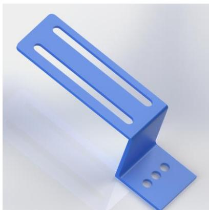
Figura 4.11: Modelo CAD, Soporte del sensor.
