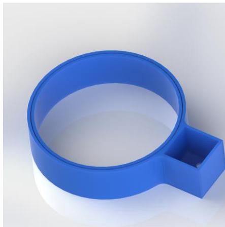
Figura 4.5: Modelo CAD, Soporte superior de la lámina de metacrilato.
