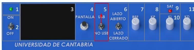
Mueva el interruptor 5 a la posición “USB”. Este modo de funcionamiento hace que la planta trabaje en sincronía, con el ordenador que esté conectado a través del puerto USB. Por tanto, este modo precisa que el ordenador, disponga de la aplicación de escritorio de la planta. El interruptor 6 y todas las ruletas del equipo carecen de funcionalidad en este modo.
