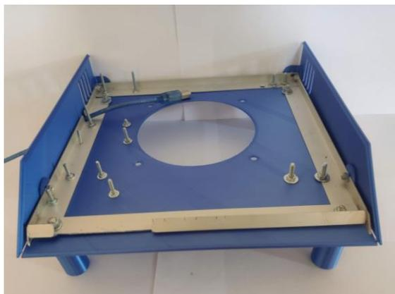
*Figura 5.5: Ensamblaje base principal-patas-bastidor y tapas laterales.*
