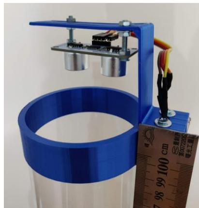
Figura 5.11: Instalación del sensor.
