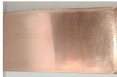
Figura 4.28: PCB de fibra de vidrio y cobre virgen.
