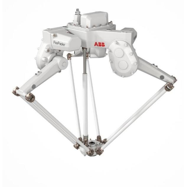
*Figura 4: Robot Delta (paralelo)*
