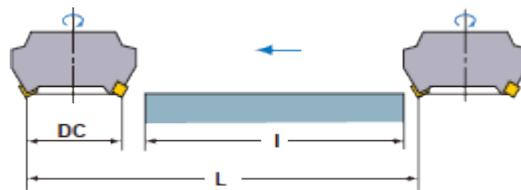
Figura 49: Distancia de corte y longitud de mecanizado
