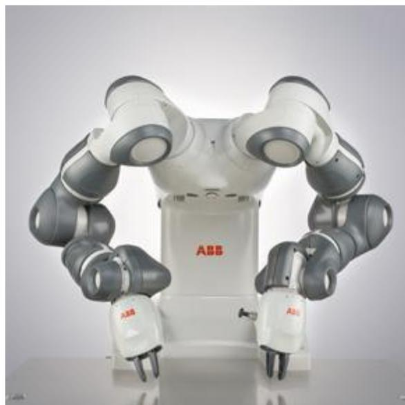
Figura 3: Robot colaborativo de ABB
