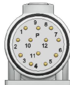
Figura 114: Esquema de los sensores en el conector
