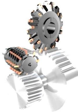
Figura 40: Fresado de engranajes (1)
