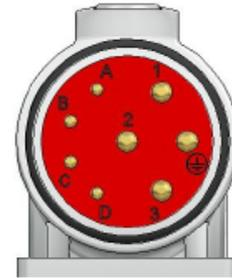
Figura 117: Esquema del conector de corriente
