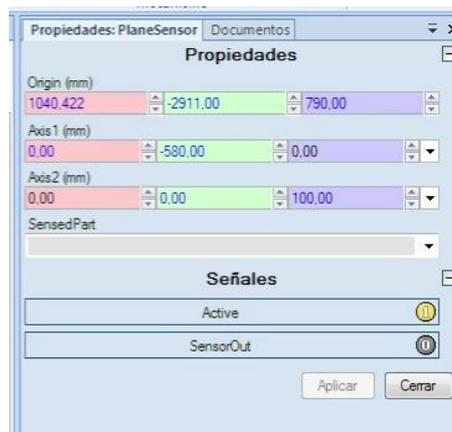
Figura 280: Configurar sensor
