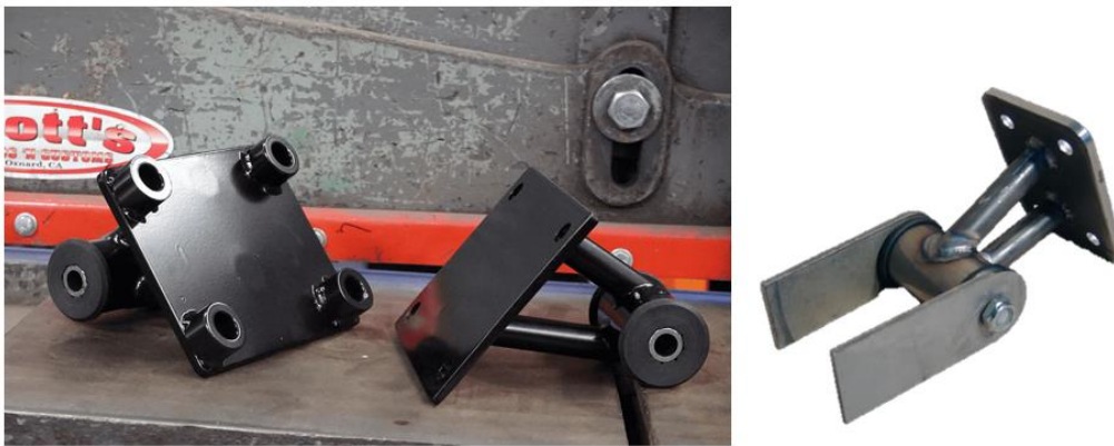
Figura 10: Ejemplo apoyos en ángulo [3]
