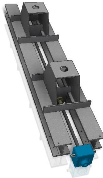
Figura 12: Ajuste de los apoyos al ancho del motor mediante husillos
