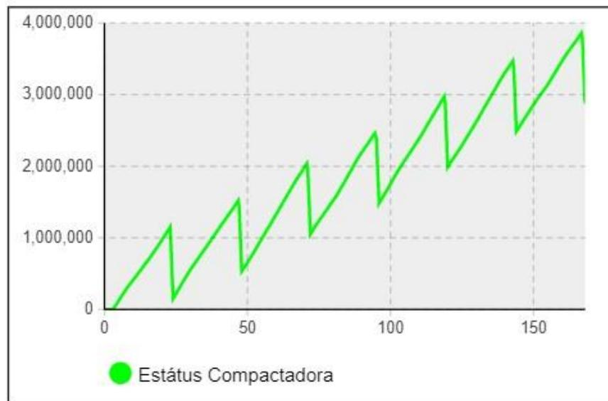
Figura 5.31. Evolución del llenado del contenedor de la compactadora a lo largo del tiempo.
