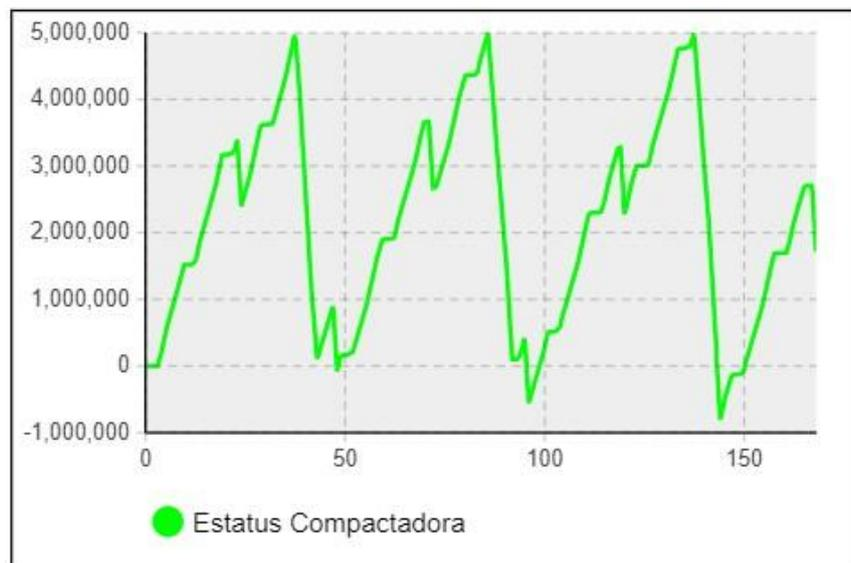
Figura 6.24. Evolución del contenedor de la compactadora tras la optimización.
