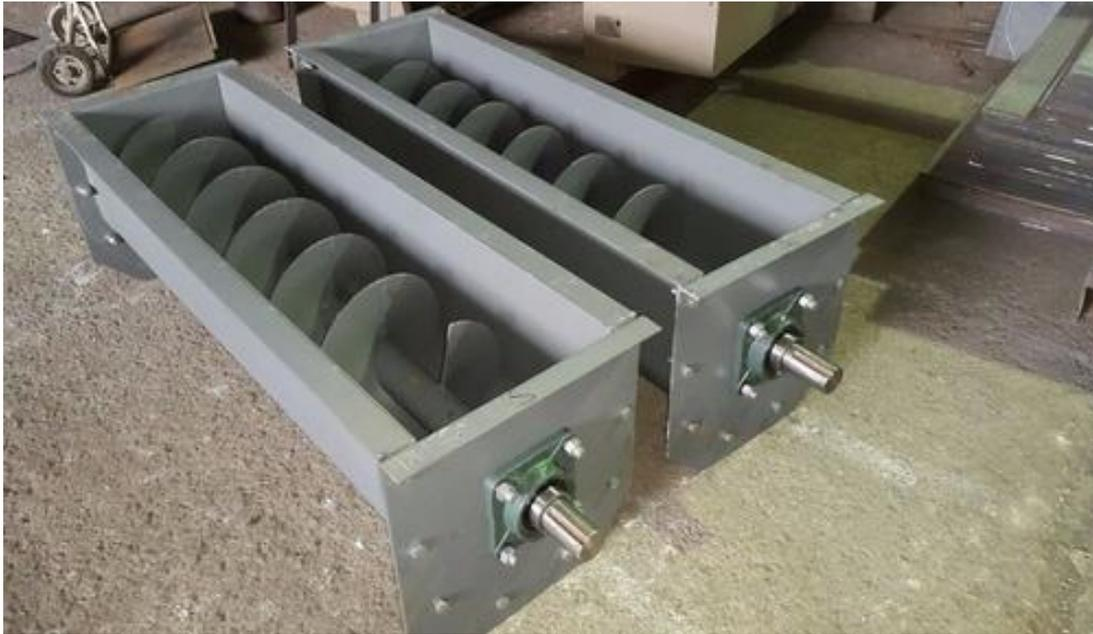
*Figura 21: Transportador de tornillo (Figura de libre acceso en Internet)*
