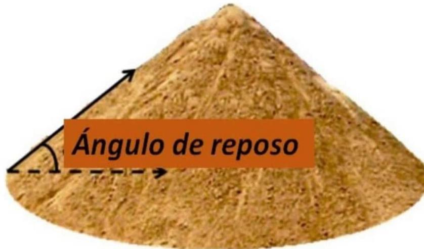
*Figura 11: Ángulo de reposo de material a granel (Figura de libre acceso en Internet)*
