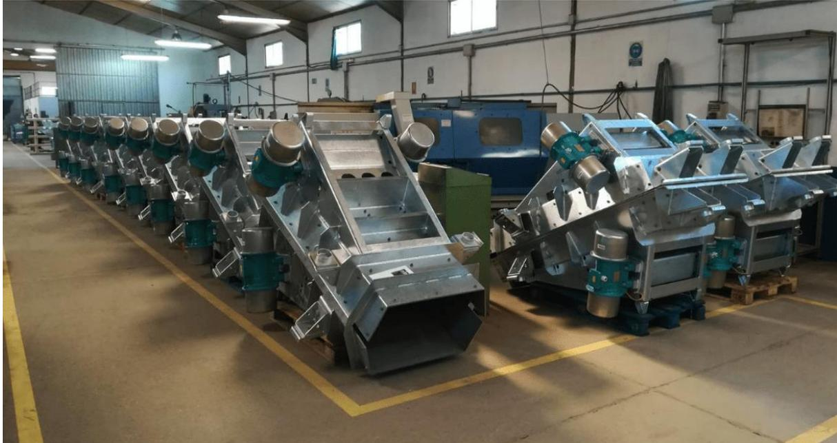
*Figura 27: Alimentador vibrante (Figura de libre acceso en Internet)*
