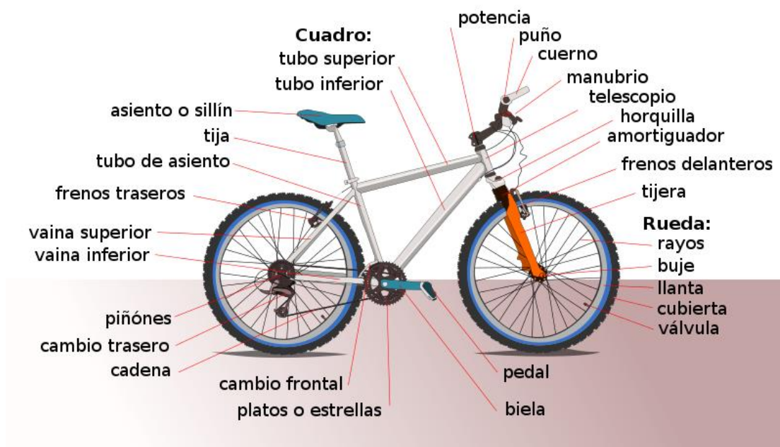
Figura 1. Partes principales de una bicicleta convencional.
