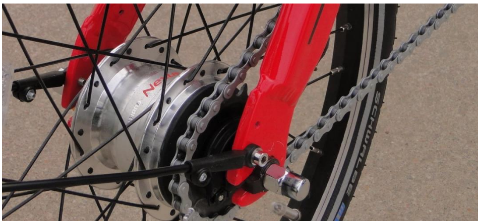
Figura 5. Bicicleta equipada con cambio de buje.
