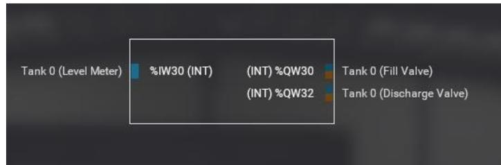
Ilustración 48: Señales implementadas para la simulación
