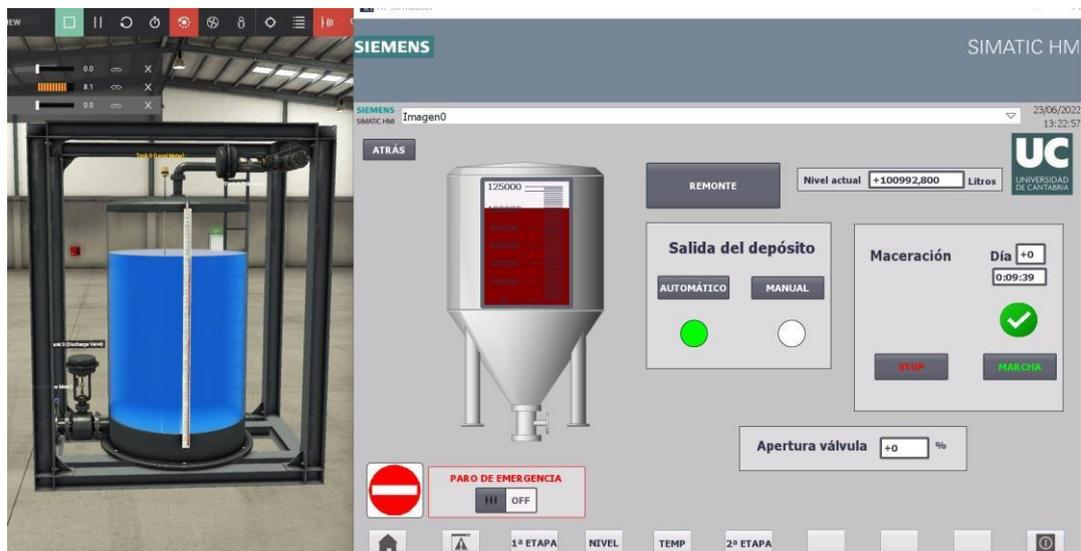
Ilustración 51: Simulación con el depósito lleno
