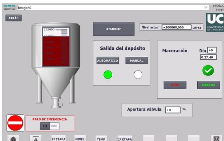
Ilustración 31: Pantalla del control del nivel
