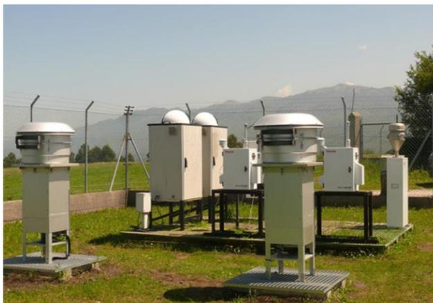
**Figura 3.4. Instrumentos para la toma de muestras de precipitación y aerosoles en la estación de la red EMEP/VAG/CAMP situada en Niembro (Asturias)**
