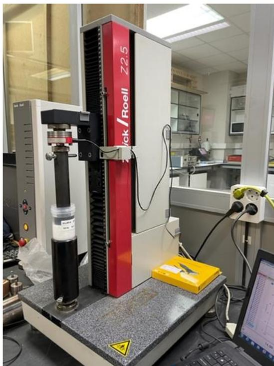
**Ilustración 27:** Ensayo de compresión sobre hidrogeles.
