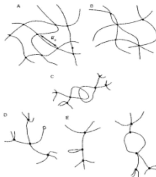
**Ilustración 4:** Estructura reticular de los Hidrogeles. A. Entrecruzamientos tetrafuncionales. B. Uniones funcionales. C. Uniones físicas. D. Funcionalidades sin reaccionar. E. Lazo en la cadena. (Fuente: (Maiolo, S. 2010))
