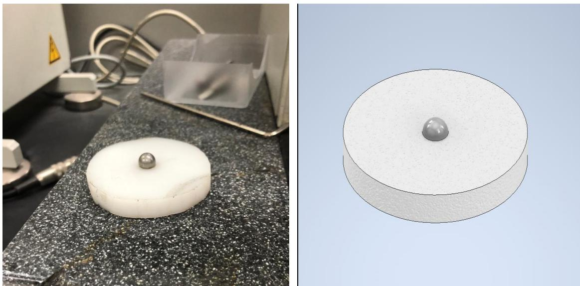
**Ilustración 16:** Sistema de rótula diseñado en 3D a través de Autodesk Inventor.
