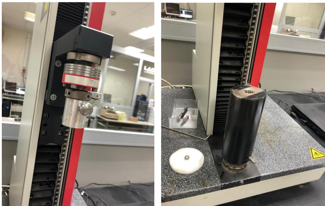
**Ilustración 14:** Transmisores de esfuerzos montados en la máquina Zwick Roell Z2.5.
