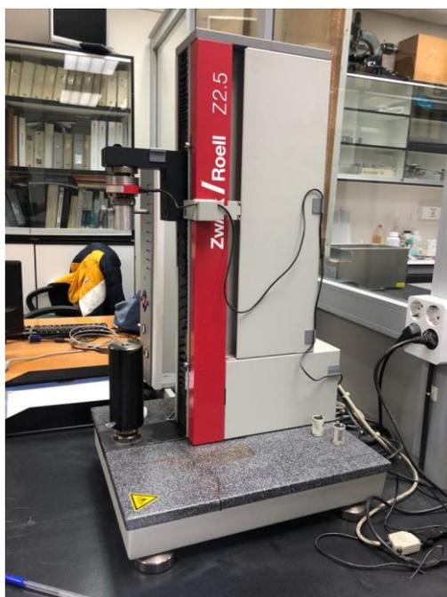
**Ilustración 11:** Máquina ZwickRoell Z2.5 empleada para la investigación.
