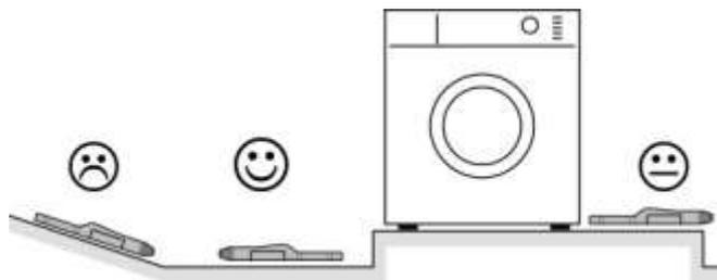
ILUSTRACIÓN 51. EJEMPLOS DE POSICIONAMIENTO DE LOS SENSORES DE INUNDACIÓN
