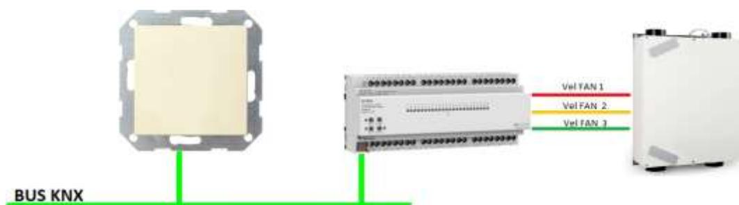
ILUSTRACIÓN 57. CONEXIONADO MÓDULOS RECUPERADORES DE CO2
