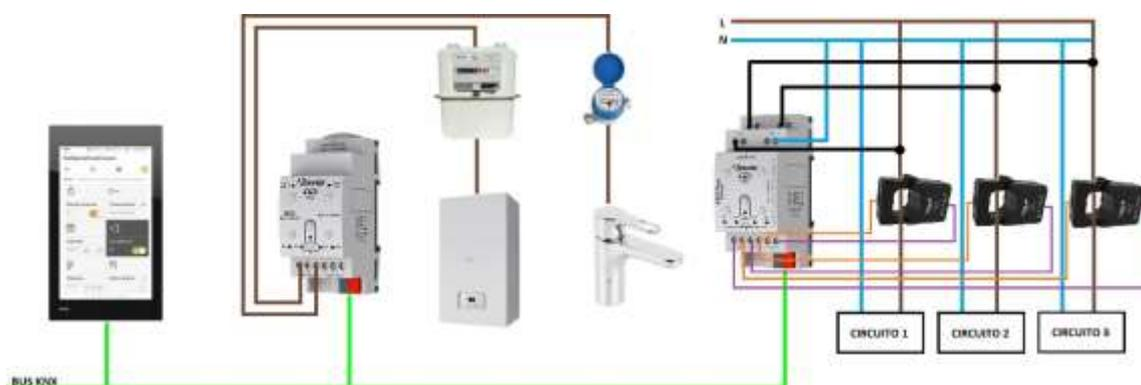
ILUSTRACIÓN 54. CONEXIONADO MÓDULOS DE MEDIDAS DE CONSUMO
