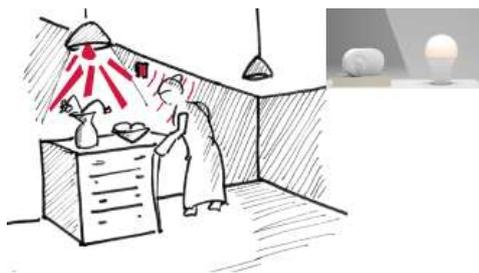
ILUSTRACIÓN 10. SENSORES DE PRESENCIA PARA ACTIVAR ILUMINACIÓN
