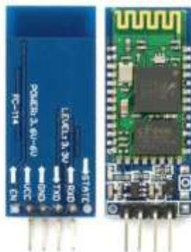
ILUSTRACIÓN 67. DISPOSITIVO BLUETOOTH HC.06
