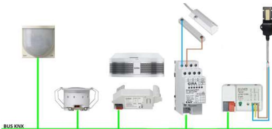
ILUSTRACIÓN 56. CONEXIONADO MODULOS SENSORIALES
