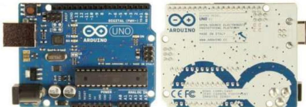
ILUSTRACIÓN 59. PLACA ARDUINO UNO.
