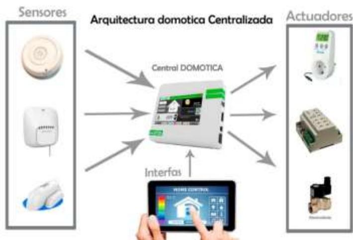
ILUSTRACIÓN 19. TOPOLOGÍA DE UN SISTEMA CENTRALIZADO.
