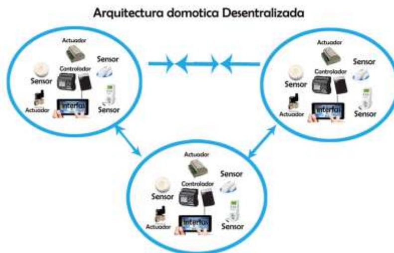
ILUSTRACIÓN 20. TOPOLOGÍA DE UN SISTEMA DESCENTRALIZADO.
