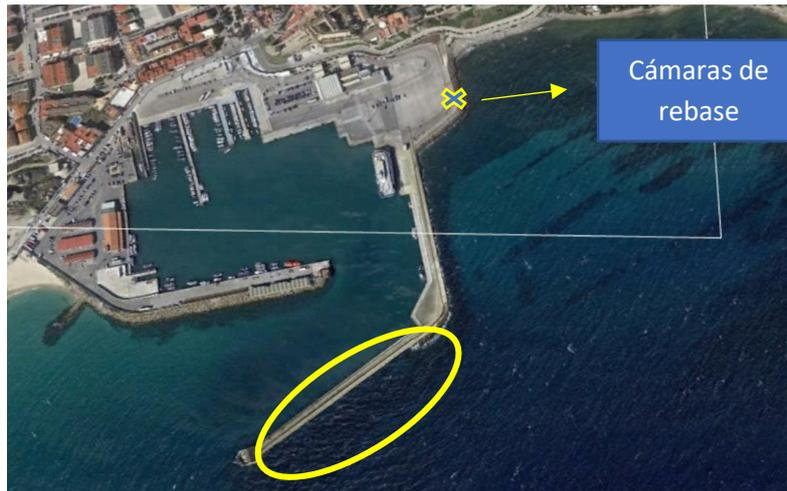
Figura 48: Posicionamiento de las cámaras de rebase del Proyecto SAFEPORT respecto al tramo VII
