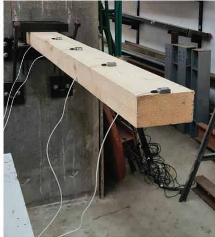
Figura 4. Análisis modal experimental realizado en laboratorio.
