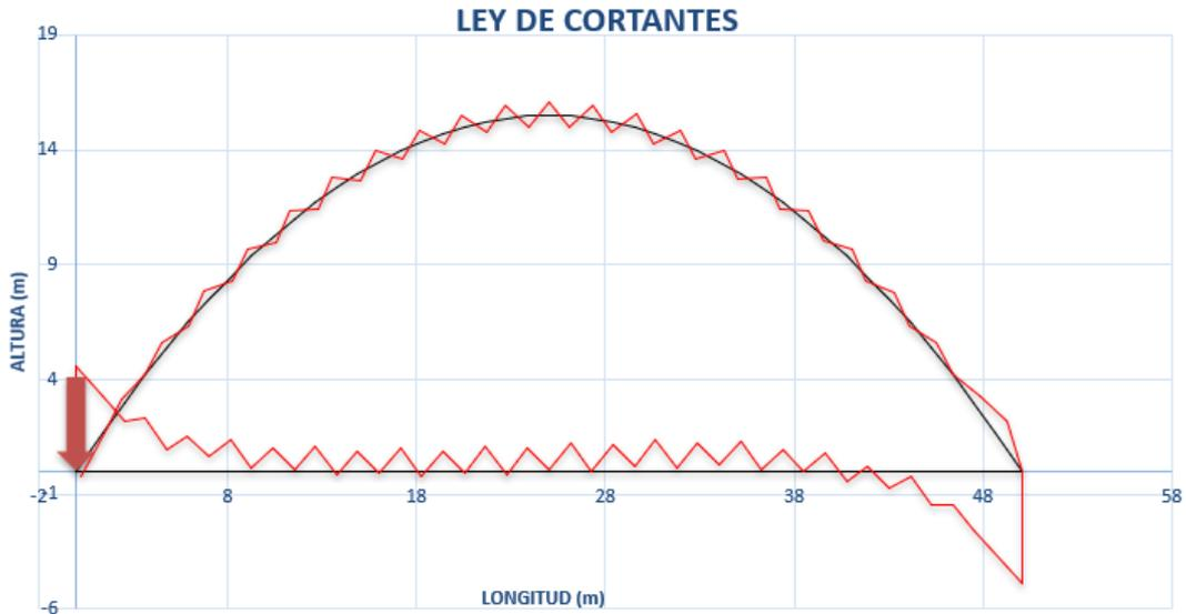
Ilustración 98: Ley de cortantes. Hipótesis 1.  $f=15,7m$ . Escala:  $1m/500 KN$
