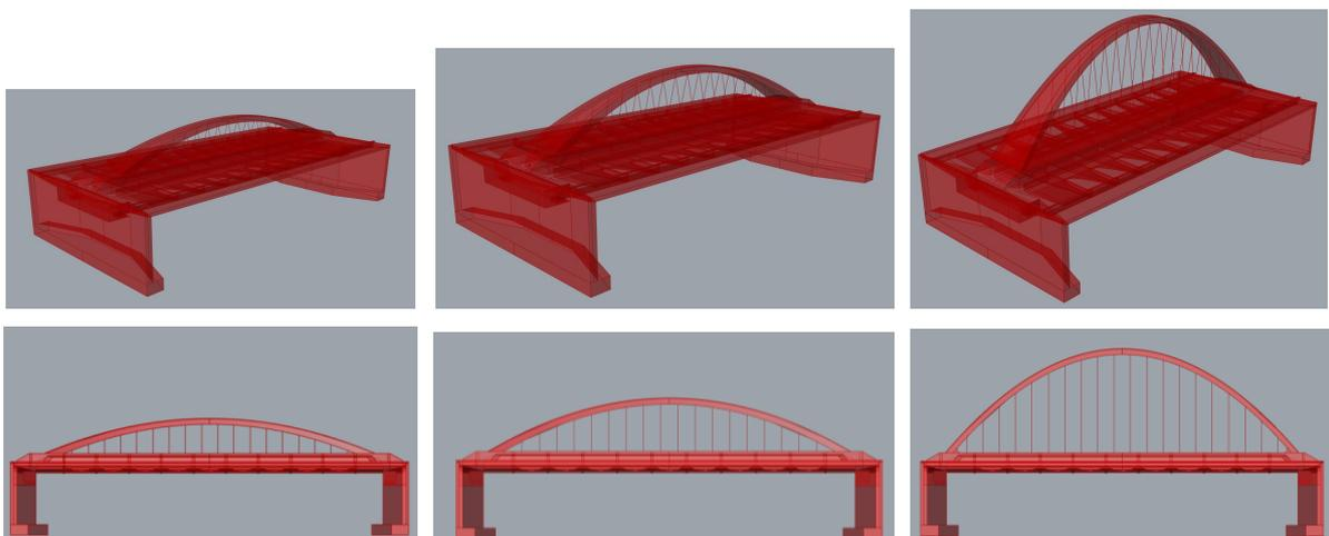
*Ilustración 166: Alternativas adoptadas en configuración de flecha/luz del arco. 1/8, 1/6 y 1/3.*
