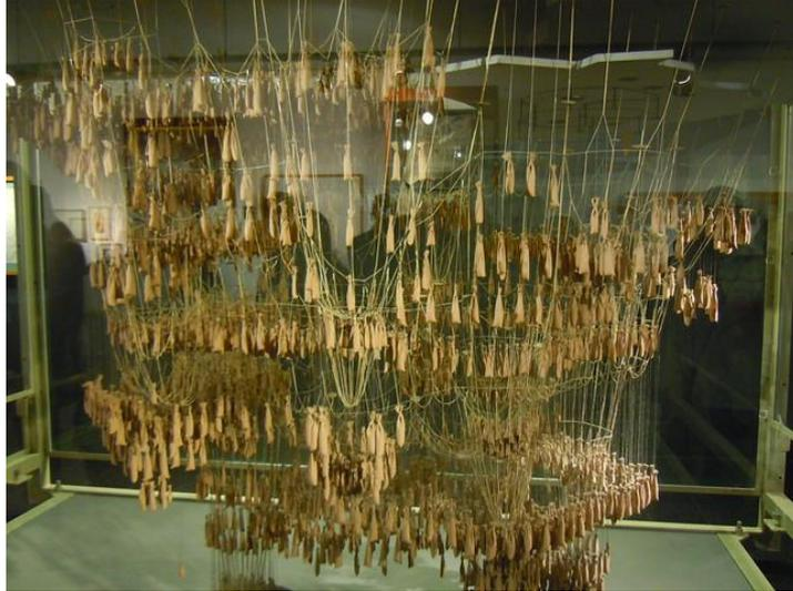
*Ilustración 101: Reproducción de la maqueta funicular de la iglesia de la colonia Güell usada por Gaudí expuesta en el Museo del Templo de la Sagrada Familia*
