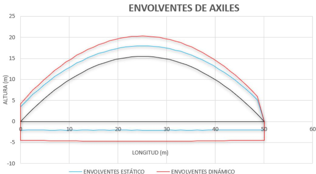
Ilustración 139: Análisis dinámico.  $V= 40 \text{ km/h}$ . Comparación de envolventes de axiles. Escala 1m/5.000 KN
