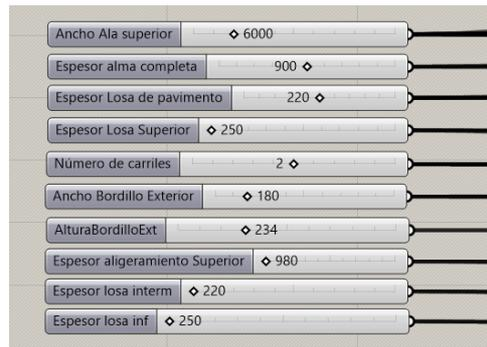
*Ilustración 29: Parámetros modificables del tablero.*
