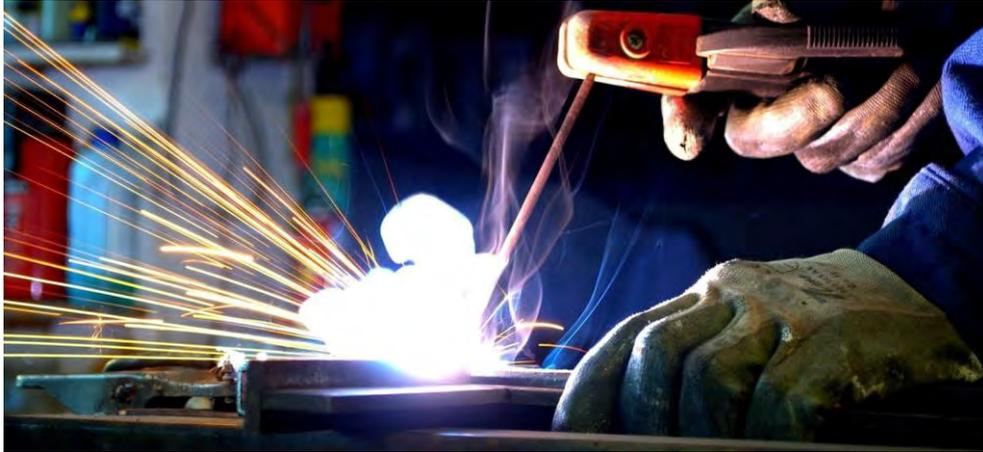
Figura 4.8: Ilustración del proceso de soldadura por arco eléctrico
