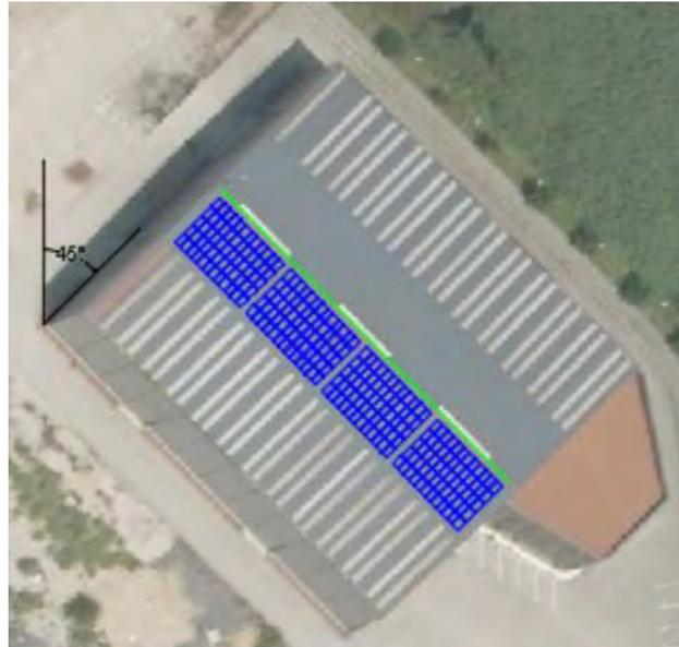
Figura 7.2: Cubierta de la nave con situación de los paneles
