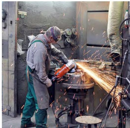
*Figura 4.7: Ilustración del proceso de rebabado*
