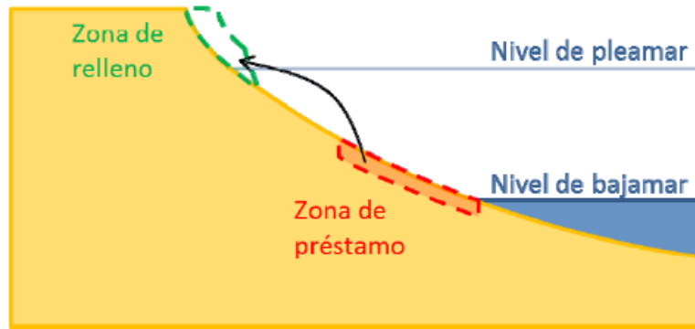
Figura 3. Esquema del movimiento de arena realizado mediante la técnica de scraping. Fuente: IH Cantabria.
