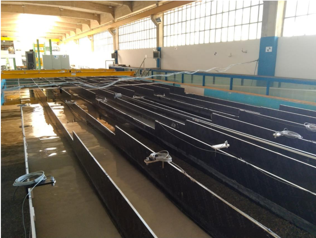
Figura 9. Fotografía real del ensayo de laboratorio. En la imagen se aprecian la configuración de los canales. Se visualiza un canal de granalla y otro de gravilla que funcionaba como acceso al tanque, los sensores acústicos de control se pueden apreciar en el borde de los paneles que separan los canales. Fotografía tomada por el autor del informe.
