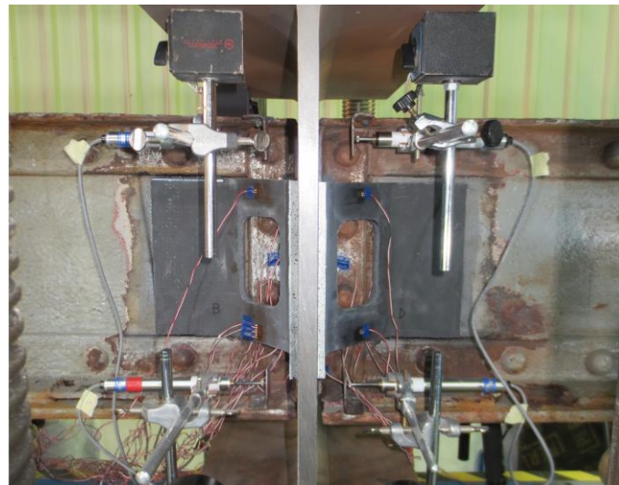
Figura 28. Ensayo de la conexión larguero-vigueta reforzada con PRFC.
