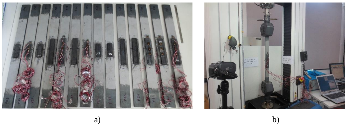
Figura 8. a) Preparación de las juntas a doble banda PRFC-acero; b) Ensayo a tracción de una junta a doble banda PRFC-acero.
