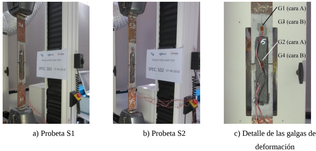
Figura 37. Configuración de ensayo e instrumentación para probetas bajo carga estática.
