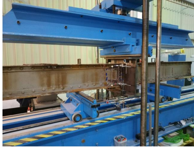
Figura 19. Ensayo de laboratorio de la conexión no reforzada en la prensa de flexión.
