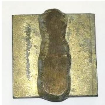
*Figura 198. Probeta NAB-NAB tras ensayos de corrosión en agua de mar*
