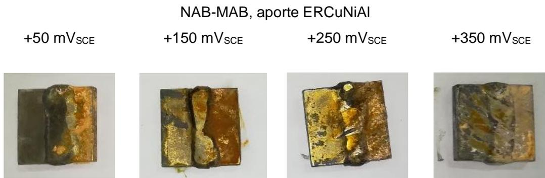
*Figura 150. Probetas NAB-MAB soldadas con ERCuNiAl y ensayadas bajo la técnica potencioestática (PS) en agua fresca simulada (SFW)*
