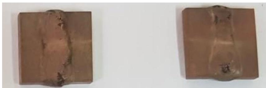
*Figura 145. Probetas MAB-MAB soldadas con ERCuMnNiAl y ensayada a corrosión bajo un potencial de -150 mV<sub>SCE</sub> (izquierda) y -100 mV<sub>SCE</sub> (derecha) en agua de mar simulada (SSW)*
