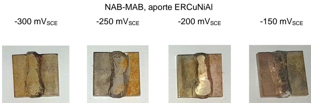
*Figura 156. Probetas NAB-MAB soldadas con ERCuNiAl y ensayadas bajo la técnica potencioestática (PS) en agua de mar simulada (SSW)*
