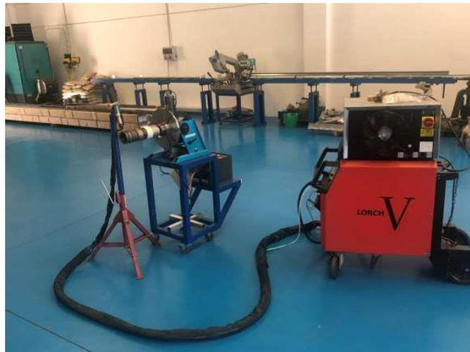
*Figura 46. Equipo de soldadura TIG utilizado en las instalaciones de LEADING.
