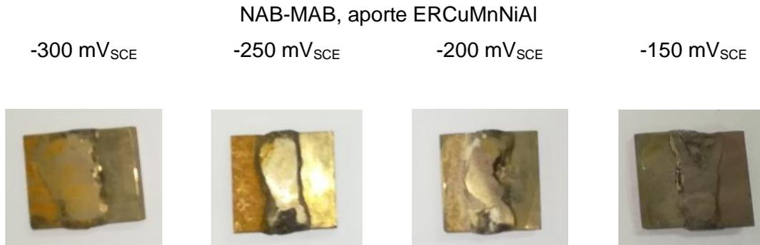
*Figura 159. Probetas NAB-MAB soldadas con ERCuMnNiAl y ensayadas bajo la técnica potencioestática (PS) en agua de mar simulada (SSW)*
