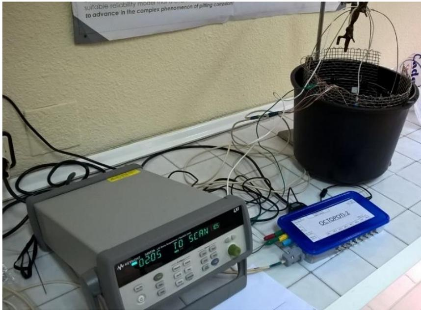
*Figura 61. Montaje general de la celda de corrosión en la Universidad de Cantabria*
