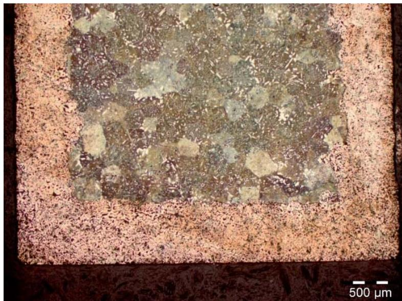
*Figura 172. Microestructuras del material MAB.T1.SW tras el efecto producido por la corrosión marina, utilizando el reactivo I (x100)*
