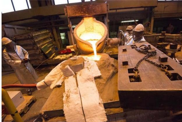
*Figura 33. Vaciado del metal líquido en un molde de arena en la empresa noruega Oshaug Metall AS. [157]*
