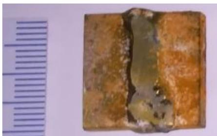
*Figura 69. Estado de la probeta soldada MAB-MAB tras el ensayo de corrosión potencioestático (PS) en agua fresca simulada (SFW)*
