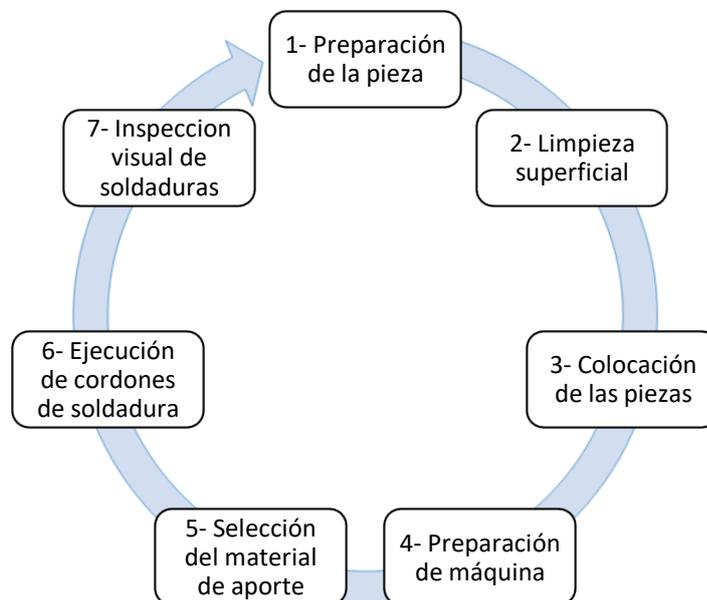
*Figura 47. Flujograma del proceso de soldadura*
