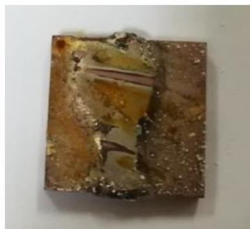
*Figura 148. Probeta MAB-MAB soldadas con ERCuMnNiAl y ensayada a corrosión bajo un potencial de +350mV<sub>SCE</sub> en agua fresca simulada (SFW)*
