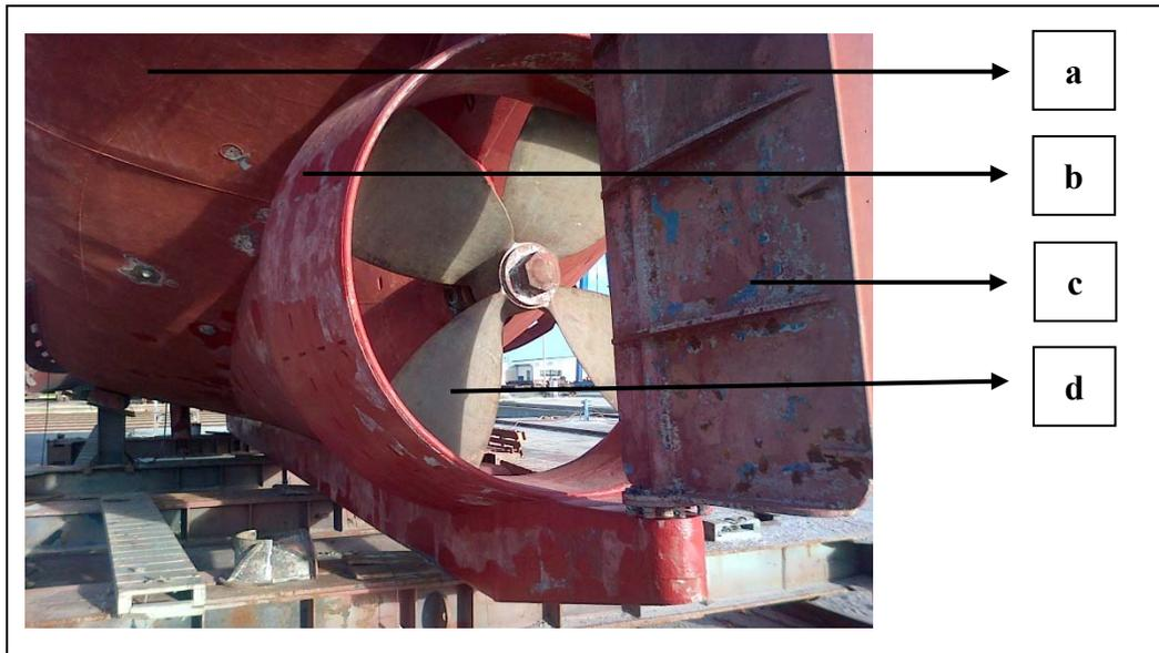
*Figura 28. Despiece casco, codaste, timón y hélice. Foto realizada in-situ en el Astillero de Peniche, Portugal (15-11-2013)*
