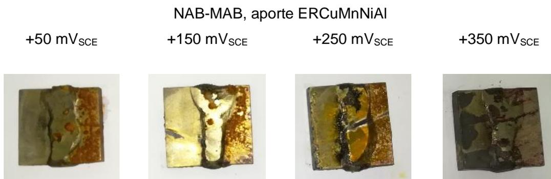
*Figura 153. Probetas NAB-MAB soldadas con ERCuMnNiAl y ensayadas bajo la técnica potencioestática (PS) en agua fresca simulada (SFW)*
