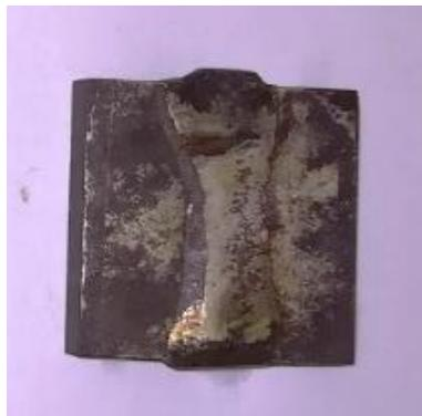
*Figura 142. Probeta NAB-NAB soldadas con ERCuNiAl y ensayada a corrosión bajo un potencial de +350mV<sub>SCE</sub> en agua fresca simulada (SFW)*
