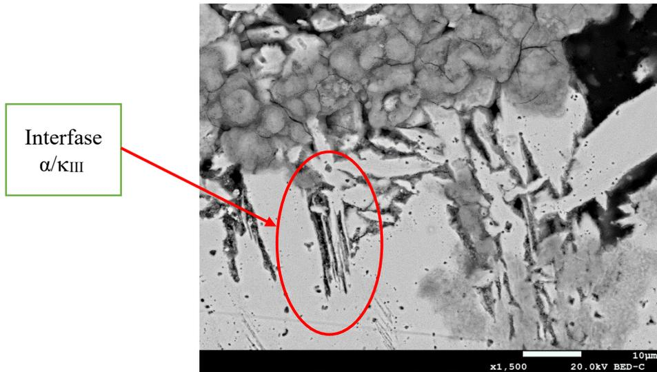
*Figura 182. Microestructura del MB de la unión soldada NAB-NAB tras el ensayo PS en SSW (x1.500)*
