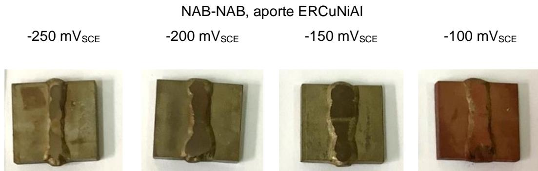
*Figura 137. Probetas NAB-NAB soldadas con ERCuNiAl y ensayadas bajo la técnica potencioestática (PS) en agua de mar simulada (SSW)*
