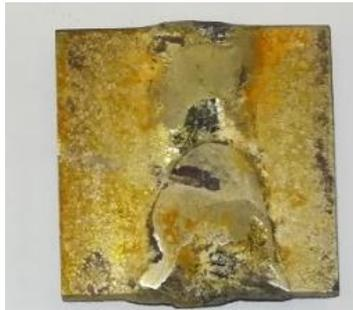
*Figura 201. Probeta MAB-MAB tras ensayos de corrosión en agua fresca*
