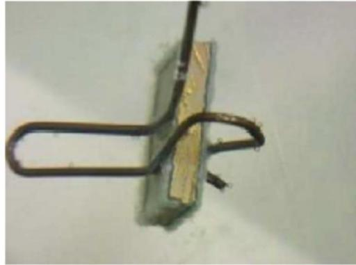
Figura 59. Detalle del electrodo de trabajo, probeta de bronce
