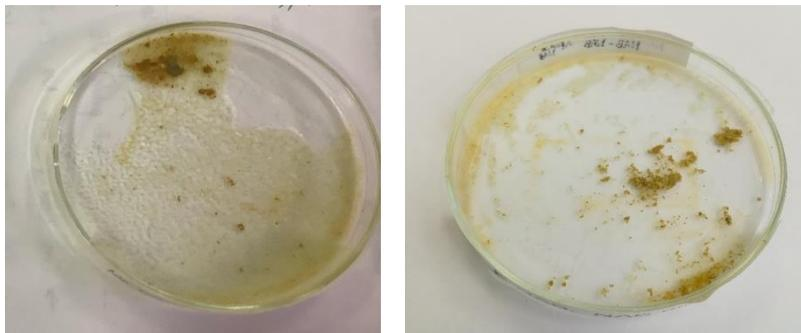
*Figura 206. Sedimento procedente del electrolito de agua de mar tras el ensayo a corrosión de la probeta NAB-NAB*
