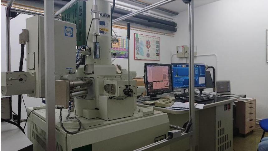
*Figura 55. Equipo de microscopía electrónica de barrido utilizado en el desarrollo de la Tesis Doctoral utilizado en la Universidad de Barcelona*
