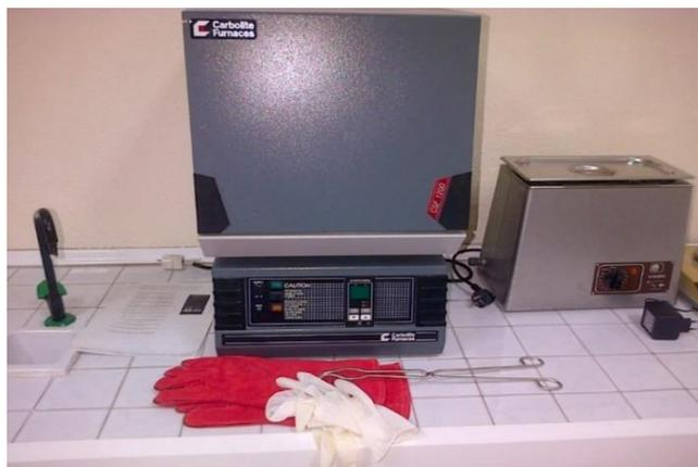
*Figura 43. Horno eléctrico de tratamientos térmicos Carbolite Furnaces CSF 1200*
