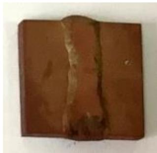
*Figura 138. Probeta NAB-NAB soldadas con ERCuNiAl y ensayada a corrosión bajo un potencial de -100mV<sub>SCE</sub> en agua de mar simulada (SSW)*
