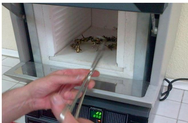
*Figura 44. Vista interior del horno en el momento que se introducen las muestras al inicio del calentamiento hasta 850 °C*
