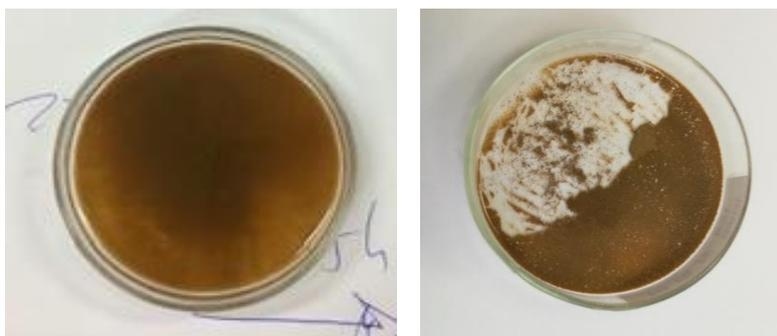
*Figura 208. Sedimento procedente del electrolito de agua fresca tras el ensayo a corrosión de la probeta MAB-MAB*
