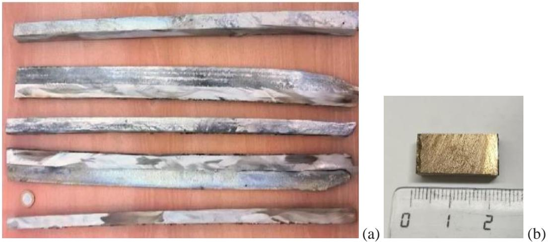
Figura 40. Lingotes de bronce MAB (a) y probeta cortada (b)
