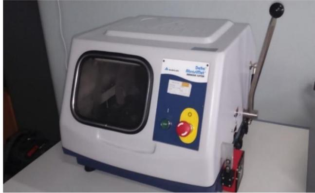
*Figura 41. Cortadora de precisión utilizada para la obtención de probetas*
