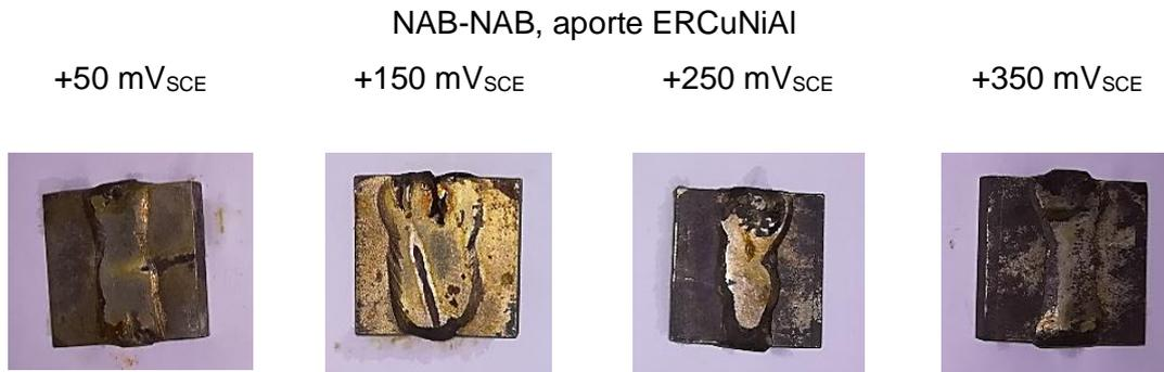
*Figura 141. Probetas NAB-NAB soldadas con ERCuNiAl y ensayadas bajo la técnica potencioestática (PS) en agua fresca simulada (SFW)*
