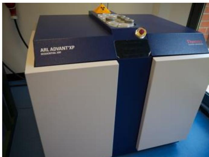
*Figura 71. Espectrómetro de Fluorescencia de Rayos X utilizado para la realización de los estudios espectroscópicos de productos de corrosión*
