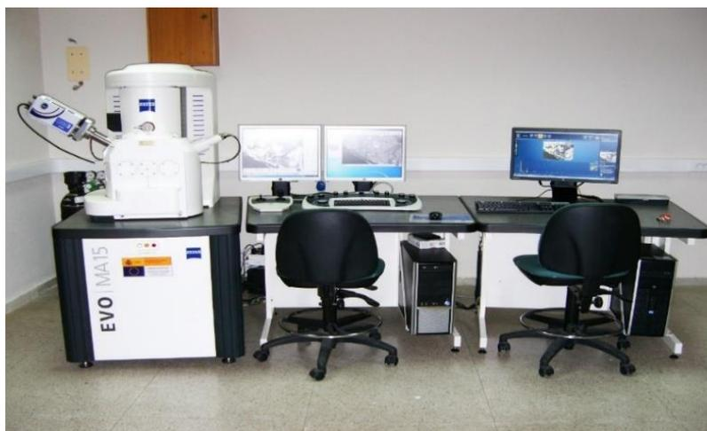
*Figura 54. Equipo de microscopía electrónica de barrido utilizado en el desarrollo de la Tesis Doctoral utilizado en la Universidad de Cantabria*
