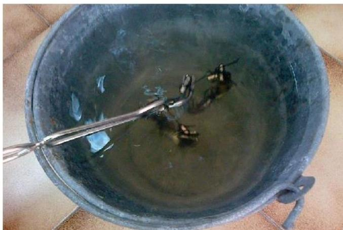
*Figura 45. Temple de las probetas tras el calentamiento a 850 °C*
