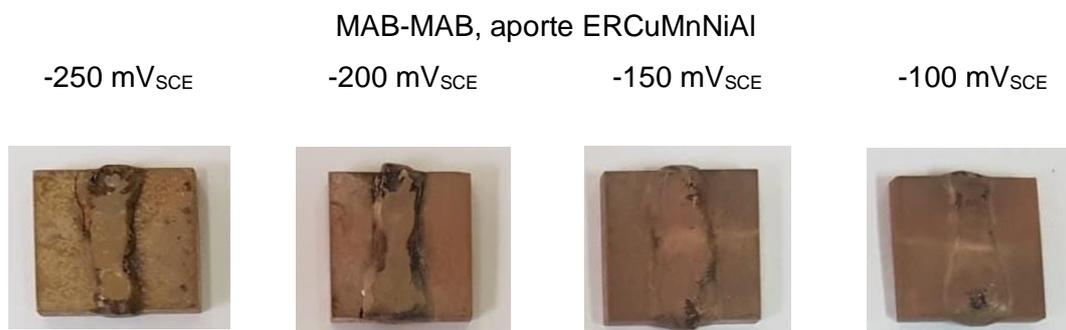
*Figura 144. Probetas MAB-MAB soldadas con ERCuMnNiAl y ensayadas bajo la técnica potencioestática (PS) en agua de mar simulada (SSW)*
