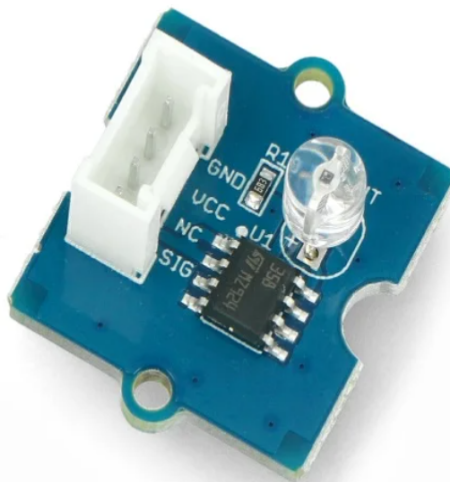
Figura 11: Imagen de un sensor lumínico.
