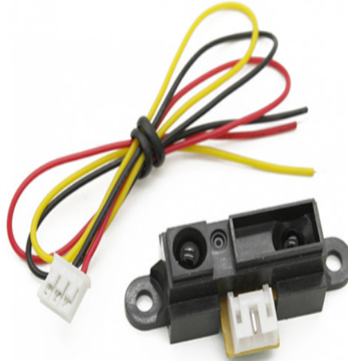
Figura 12: Imagen de un sensor de distancia óptico.
