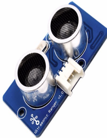
Figura 13: Imagen de un sensor de distancia de ultrasonidos.
