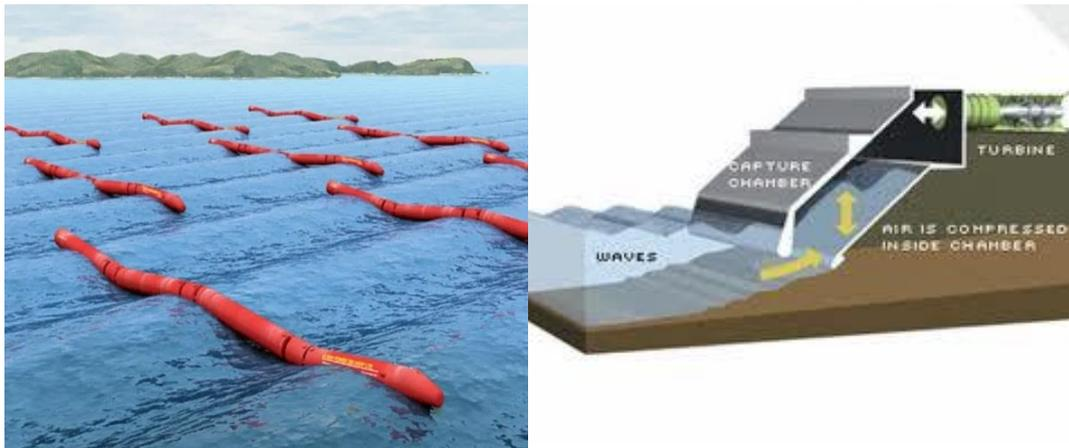
Ilustración 22. Sistemas “Balsa de Cockerell” y “columna de agua oscilante”
