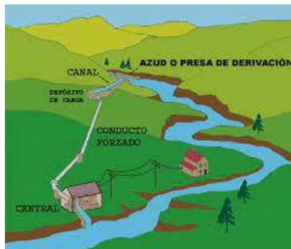
Ilustración 8. Esquema funcionamiento de una central hidroeléctrica de agua fluyente
