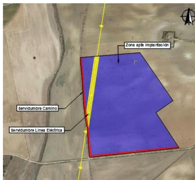
Ilustración 35: Superficie de proyecto óptima según condicionantes sobre el terreno
