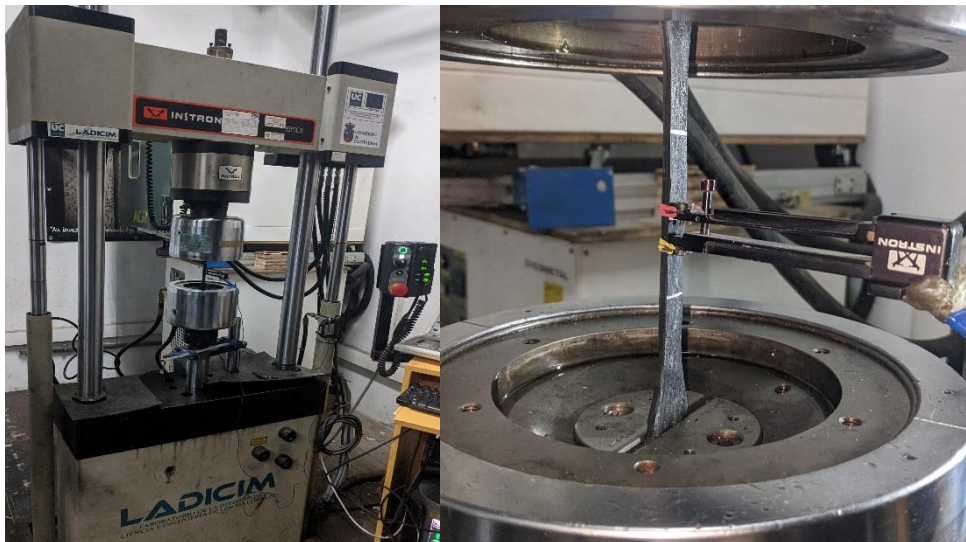
Fig. 4.2 Máquina servohidráulica universal Instron utilizada y detalle del montaje experimental.
