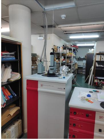
Figura 10: Magnetómetro SQUID.
