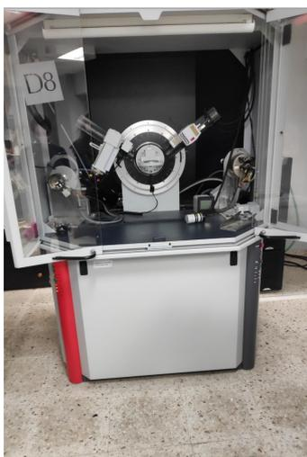
Figura 9: Difractómetro D-8 Bruker Advanced empleado para la caracterización estructural.
