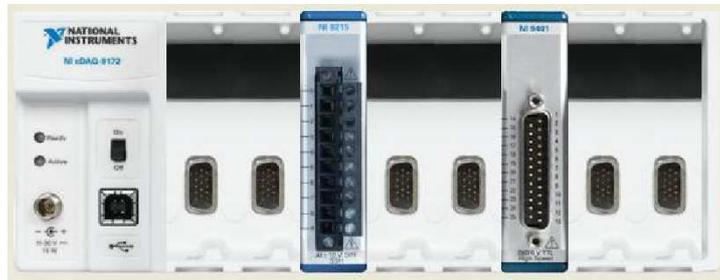
Fig 4.3.- Chasis cDAQ 9172 con las dos tarjetas de adquisición.
