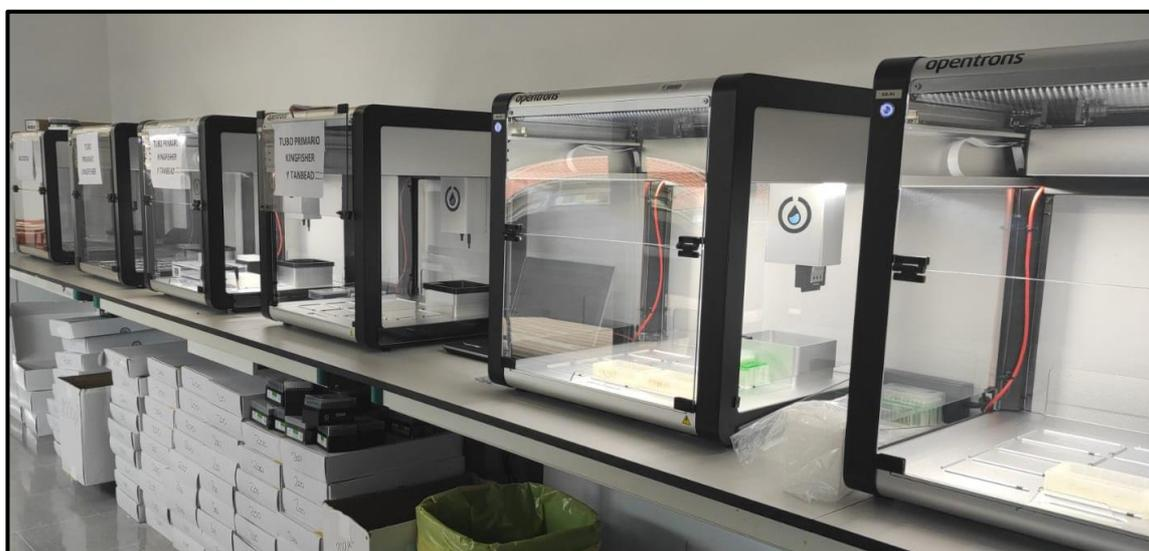
**Ilustración 18.** Estación robótica “Opentrons” en el servicio de Microbiología del HUMV.
