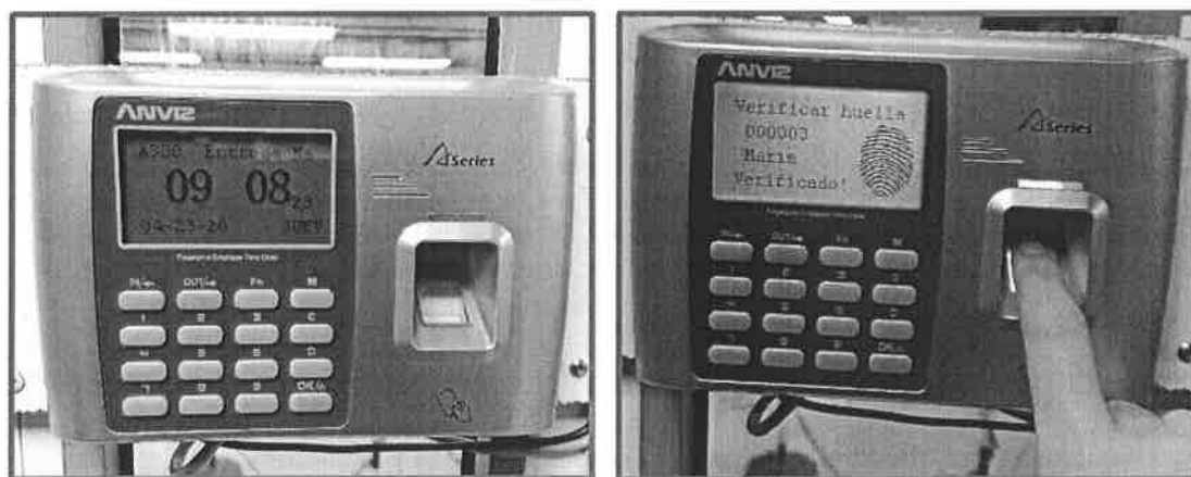
Ilustración 4.3. Sistema de control biométrico por huella dactilar.
