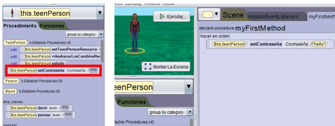
Figura 4.3. Procedimiento para dar valor a una variable en el código.
