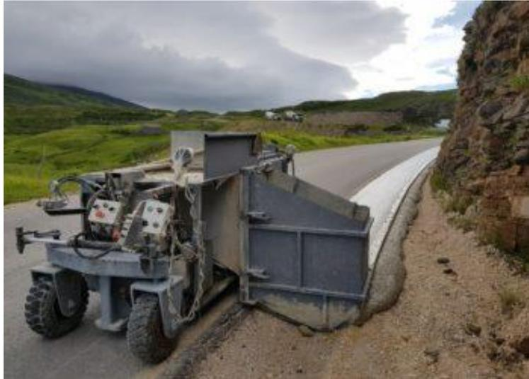
Figura 6. Máquina cunetadora a emplear en la construcción de la cuneta VA-75.
