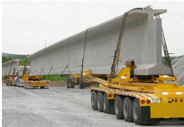
*Figura 26. Transporte con dolly de vigas prefabricadas de tipo doble T.*
