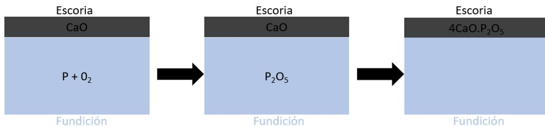
**Figura 2.7** Diagrama esquemático del proceso de desfosforización del acero.
