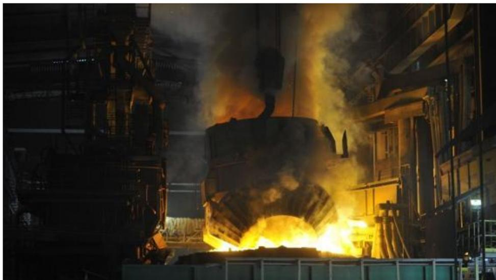
**Figura 2.5** *Proceso de carga mediante el vertido de la cesta de chatarra en el interior del horno*[9].
