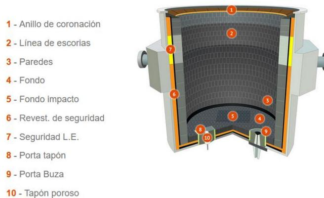
**Figura 2.12** Representación de un horno cuchara en el que se indican algunas de sus principales partes[14].
