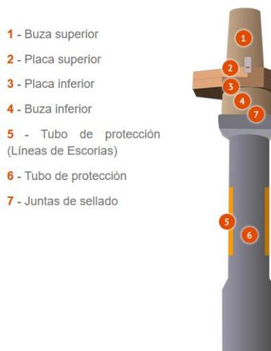
**Figura 2.14** Representación de las partes principales de una buza[14].
