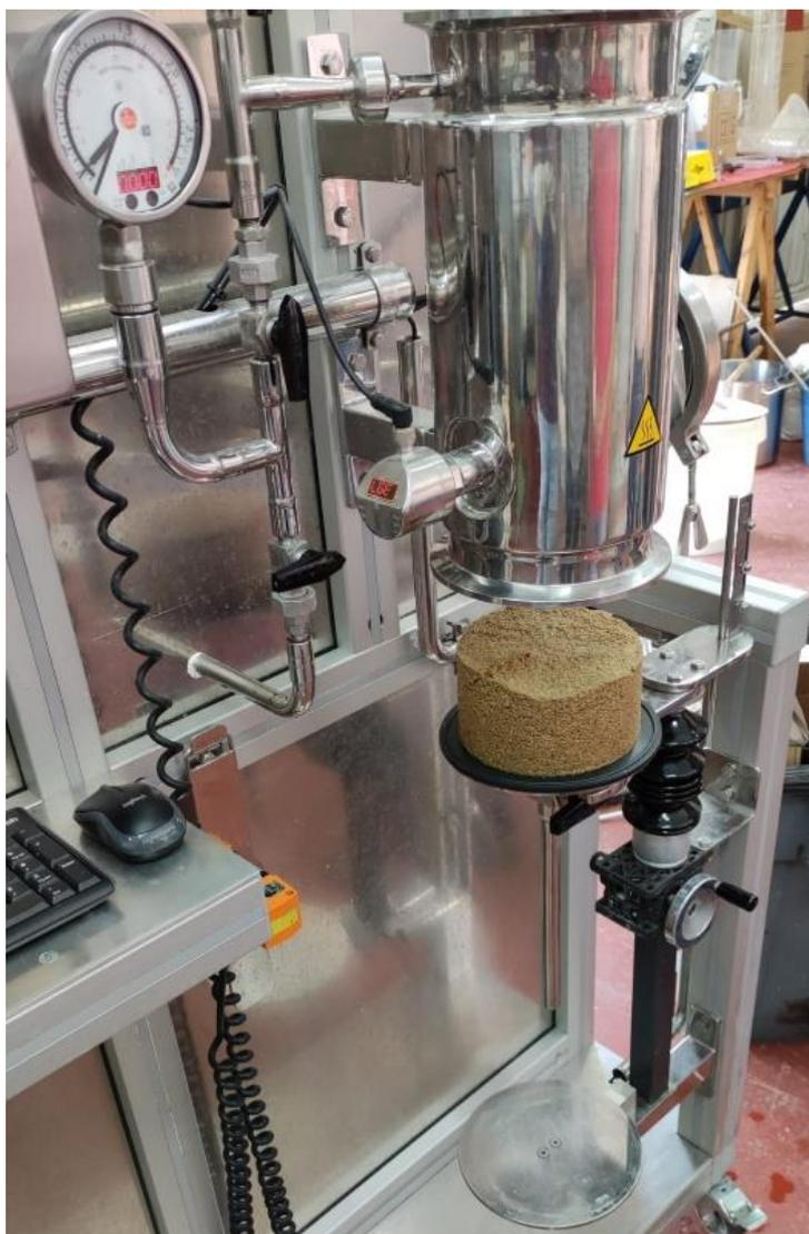
*Figura 4.15 Torta producida al finalizar la filtración. Elaboración propia.*
