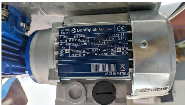
Figura 4.4 Placa del motor eléctrico del agitador. Elaboración propia.
