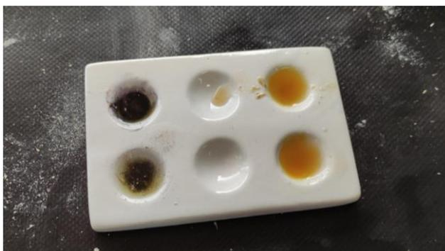
Figura 4.11 Test de yodo. A la izquierda dos muestras de agua con molienda sin macerar, a la derecha muestra ya sacarificada. Elaboración propia.
