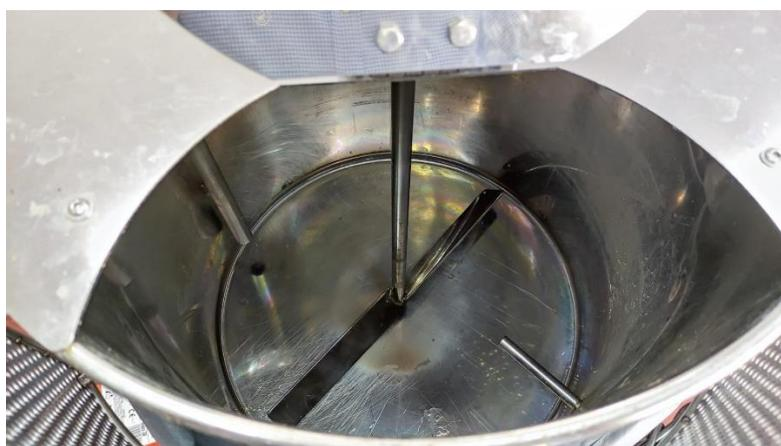
Figura 4.5 Palas del agitador. Elaboración propia.
