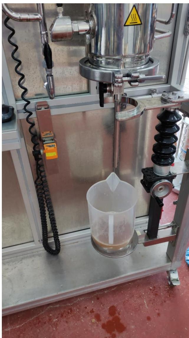
*Figura 4.13 Filtración de mosto en Fk meter. Elaboración propia.*
