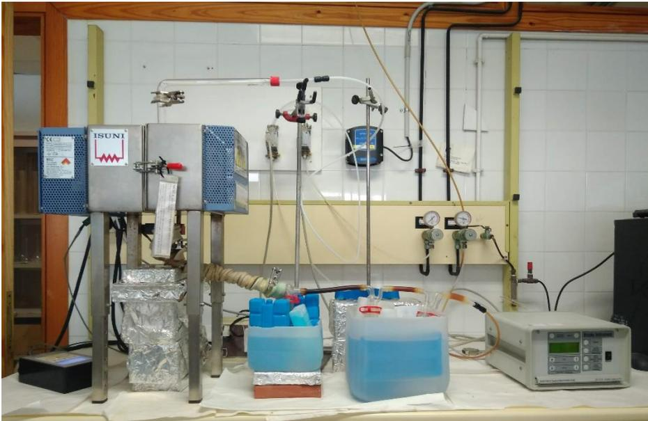
Imagen 4: Planta de pirólisis a escala laboratorio
