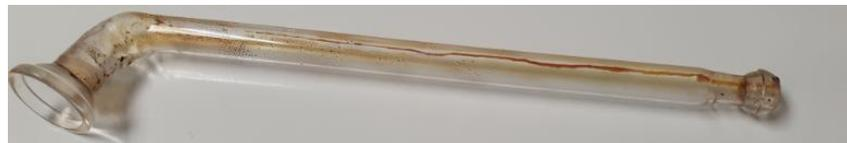
Figura 13 Codo de abajo después de pirólisis
