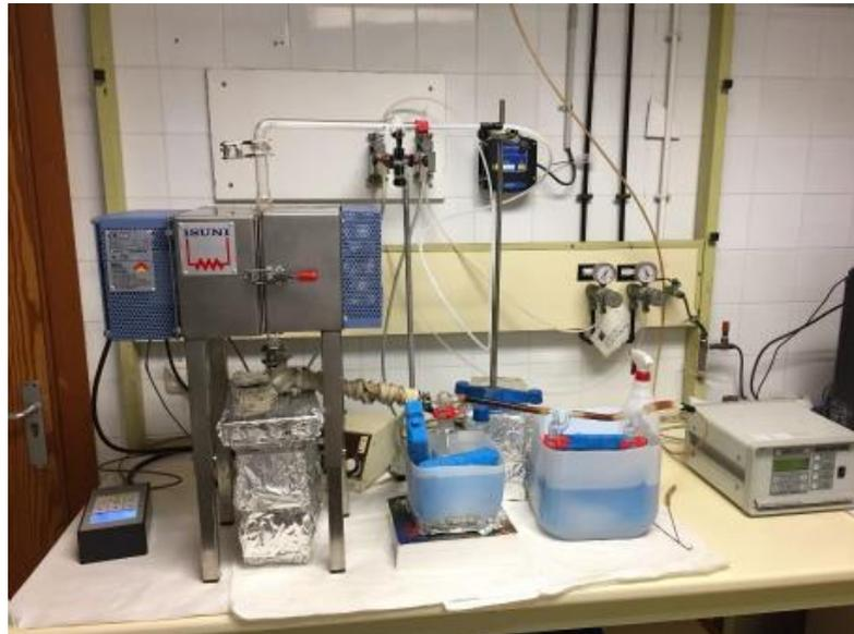
*Figura 5 Equipo de pirólisis a nivel de laboratorio*
