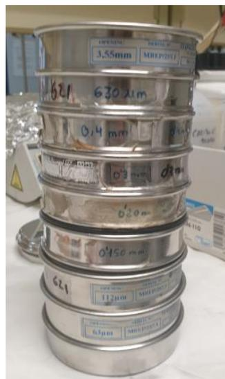
Figura 14 Tamices con distinta luz de malla
