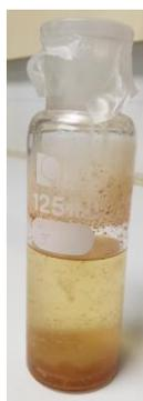
Figura 11 Borboteador con NaOH después de pirólisis
