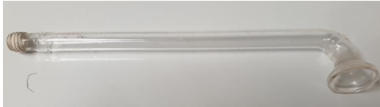
Figura 12 Codo de arriba después de pirólisis
