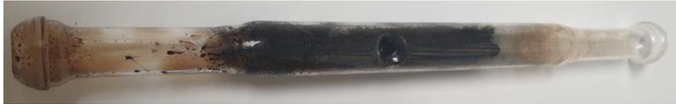
Figura 7 Reactor después de pirólisis
