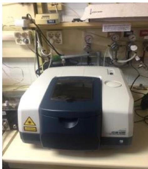
Figura 21 Espectrómetro IR-FT Jasco 4200LE
