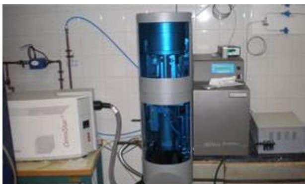
Figura 22 Analizador térmico Setaram y espectrómetro de masas Balzers ThermoStar
