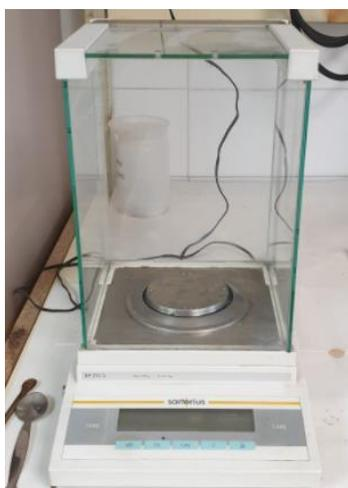
Figura 18 Balanza de alta precisión
