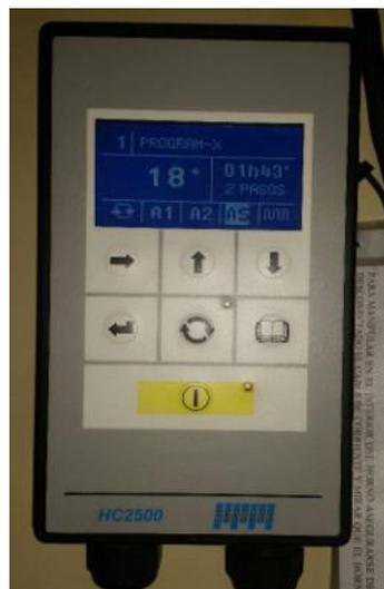
Figura 8 Controlador PID de temperatura
