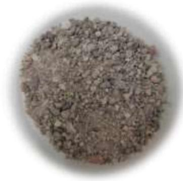
*Fig. 5. Dolomía original utilizada en los experimentos.*
