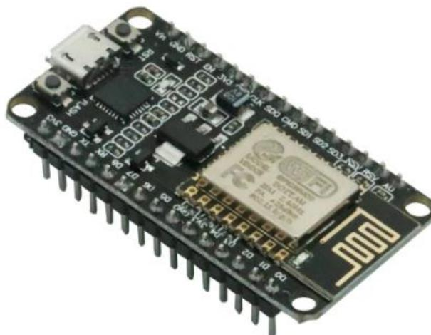
*Figura 25 – NodeMCU v3 Fuente: [27].*
