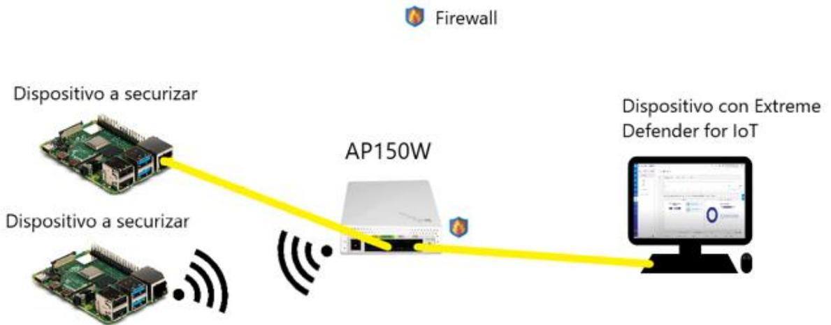
Figura 18 – Esquema de conexión AP150W Fuente: Elaboración propia
