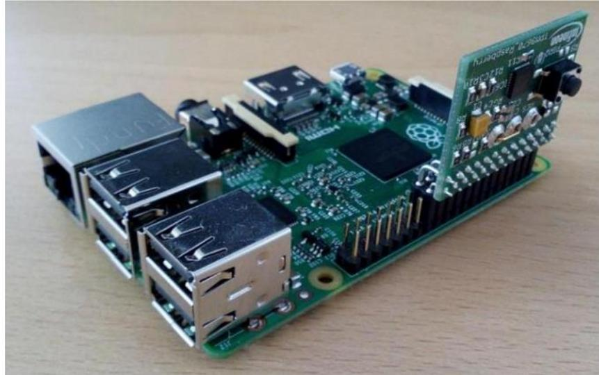
*Figura 19 – Raspberry Pi con el módulo Iridium9670 TPM2.0 LINUX*
