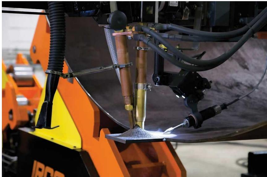
*Figura 15: Soldadura SAW [36].*
