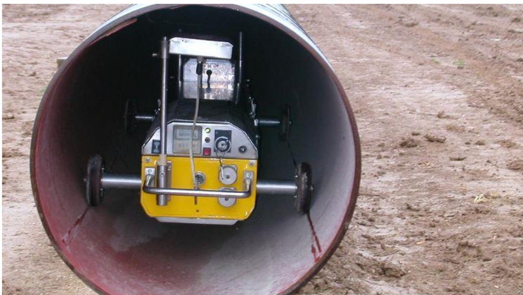
*Figura 33: Inspección mediante métodos radiográficos [54].*
