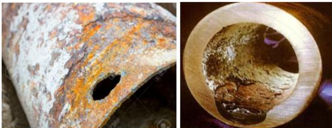
*Figura 49: Disminución del espesor de la pared de la tubería por corrosión [3].*
