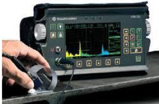
Figura 34: Ejemplo de inspección por ultrasonidos convencional [58].
