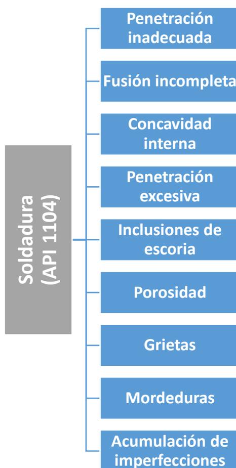
Figura 22: Defectos de soldadura según norma API 1104 [48].
