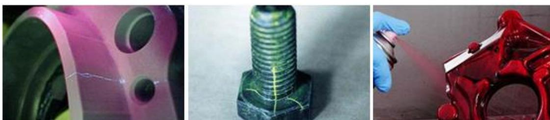
Figura 31: Aplicación y detección mediante líquidos penetrantes [51].
