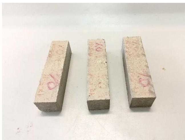
Figura 24. Probetas de mortero autonivelante con 0% de filler residuo.
