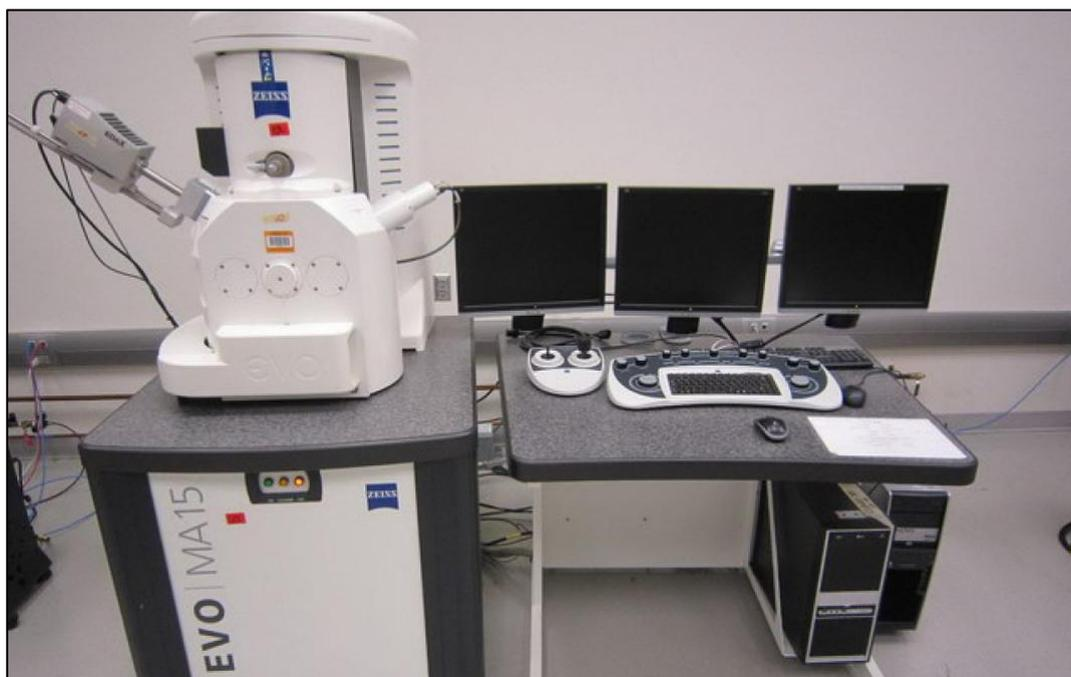
Figura 15. Imagen del microscopio electrónico de barrido (SEM).
