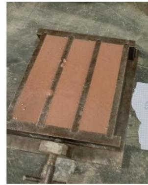
*Figura 47. Mortero autonivelante 100% filler residuo.*
