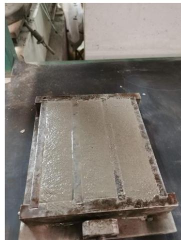
*Figura 41. Moldes al 100% de llenado tras el vibrado y 0% residuo.*
