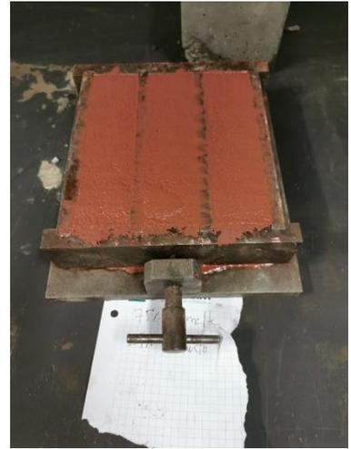
*Figura 44. Moldes al 100% de llenado tras el vibrado y 75% residuo.*
