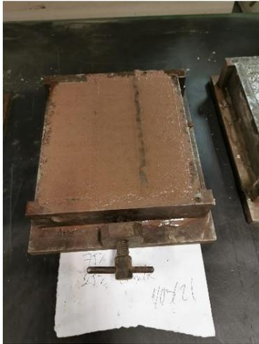
*Figura 42. Moldes al 100% de llenado tras el vibrado y 25% residuo.*
