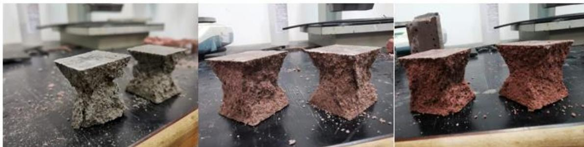
*Figura 58. Resultados de los morteros tras los ensayos en la fase 1.*
