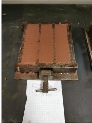
*Figura 43. Moldes al 100% de llenado tras el vibrado y 50% residuo.*
