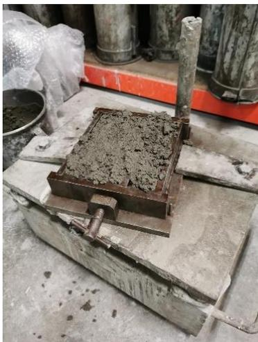
*Figura 40. Moldes al 100% de llenado sin vibración.*
