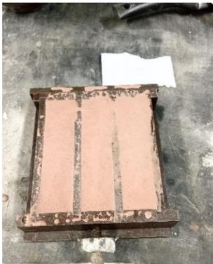
*Figura 45. Mortero autonivelante 25% filler residuo.*
