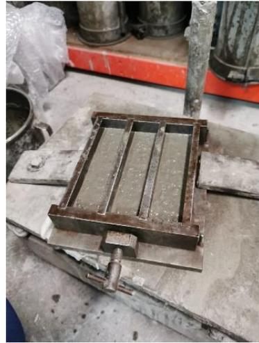
*Figura 39. Moldes al 50% de llenado tras el vibrado.*
