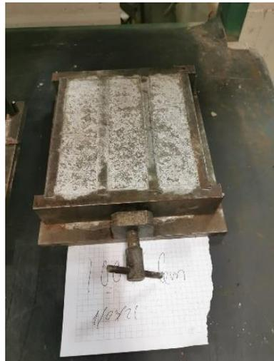
Figura 50. Probetas de mortero secas tras 24 horas, en este caso 0% de residuo.
