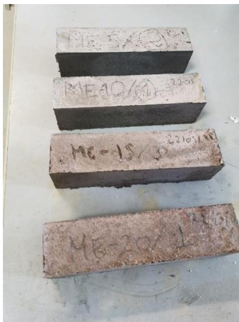
Figura 23. Probetas con 5%, 10%, 15% y 20% de residuo de la fase 2.
