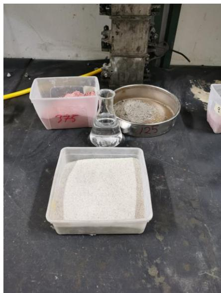
Figura 12. Esmalte vitreo superior a la izquierda, cemento Portland superior a la derecha, agua en el medio y arena fina en la parte inferior.
