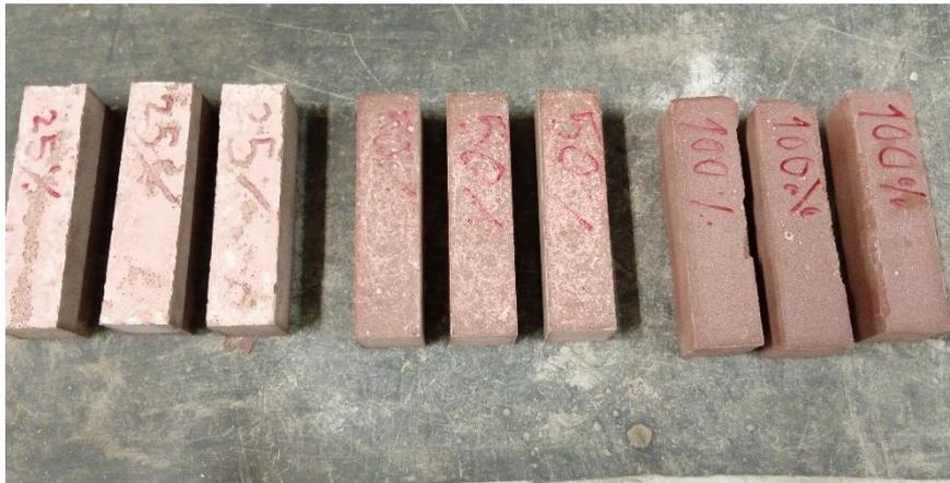
Figura 25. Probetas de mortero autonivelante con 25%, 50% y 100% de filler residuo.
