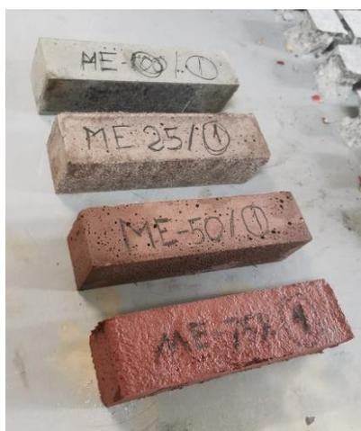
Figura 22. Probetas de la fase 1 desmoldadas y con sus respectivos porcentajes de residuo.
