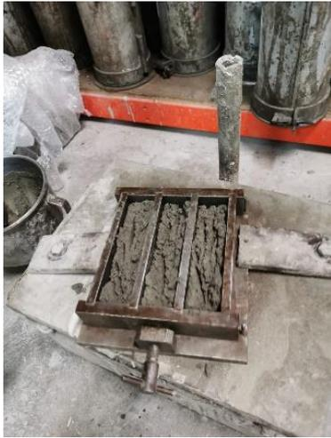
*Figura 38. Moldes al 50% de llenado sin vibración.*
