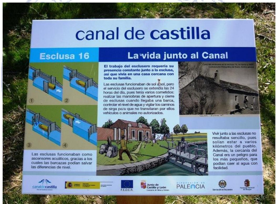
Fuente (7): Sistema de funcionamiento de esclusas. Junto a la esclusa 16.
